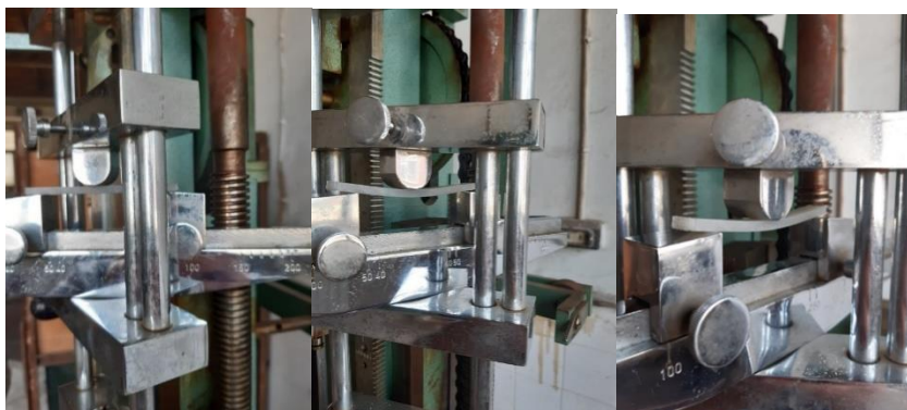
Сурет 34 - Композиттердің иілуіндегі кернеулерді анықтау.
