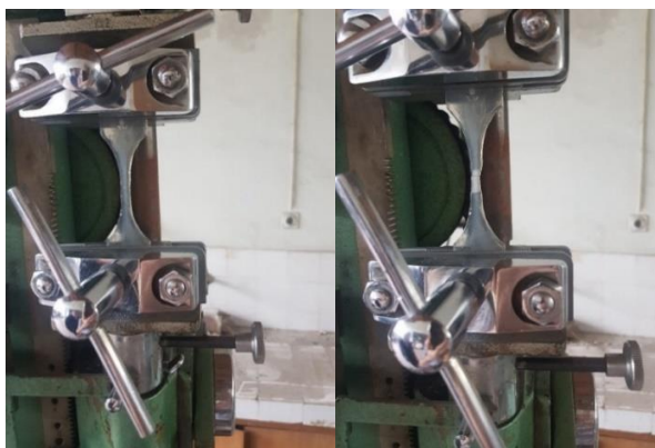
Сурет 25 - үзілген кезде мойынның пайда болуы
