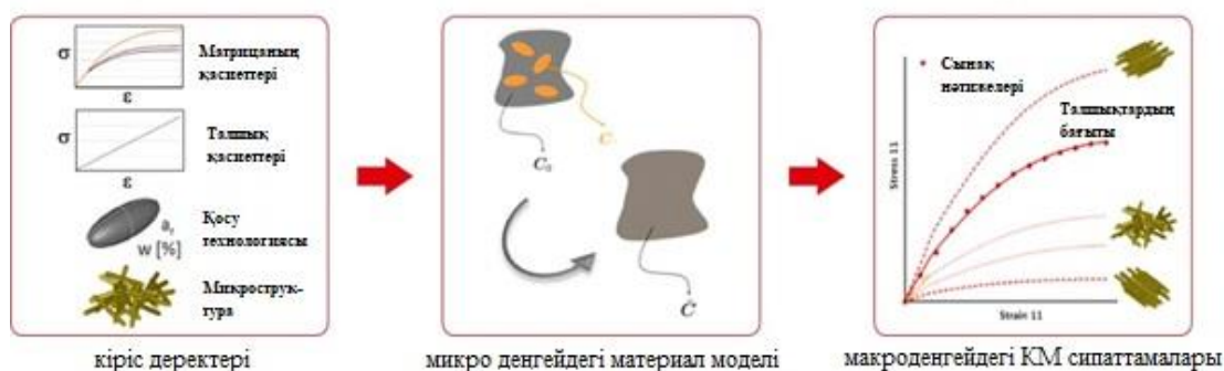
Сурет 7 – Композициялық материалдардың сипаттамаларын анықтауға арналған микродеңгейлі тәсіл
