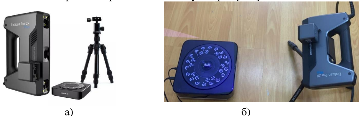
Сурет 57 - Shining 3D EinScan Pro 2X Plus а) Сканердің толық жиынтығы б) Жұмыс жасау процесі
