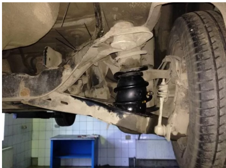
Рисунок 1.6 – Самодельное комбинирование винтовой пружины и пневмобаллона автомобиля
