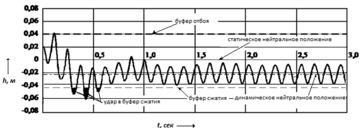
Рисунок 3.8 – Процесс колебания точки крепления пневмопружины к раме тележки
