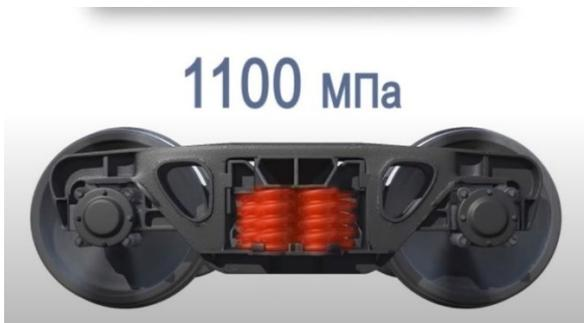
Рисунок 4.6. Запас прочности прутка пружины
