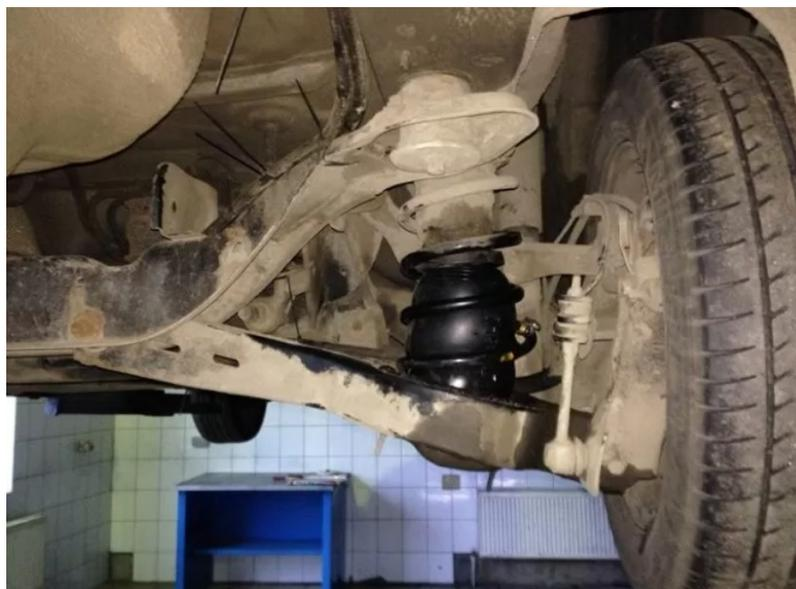
Рисунок 1.6 – Самодельное комбинирование винтовой пружины и пневмобаллона автомобиля
