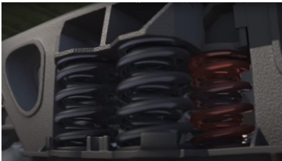
Рисунок 4.1. Нагрузка под клиновых пружин
