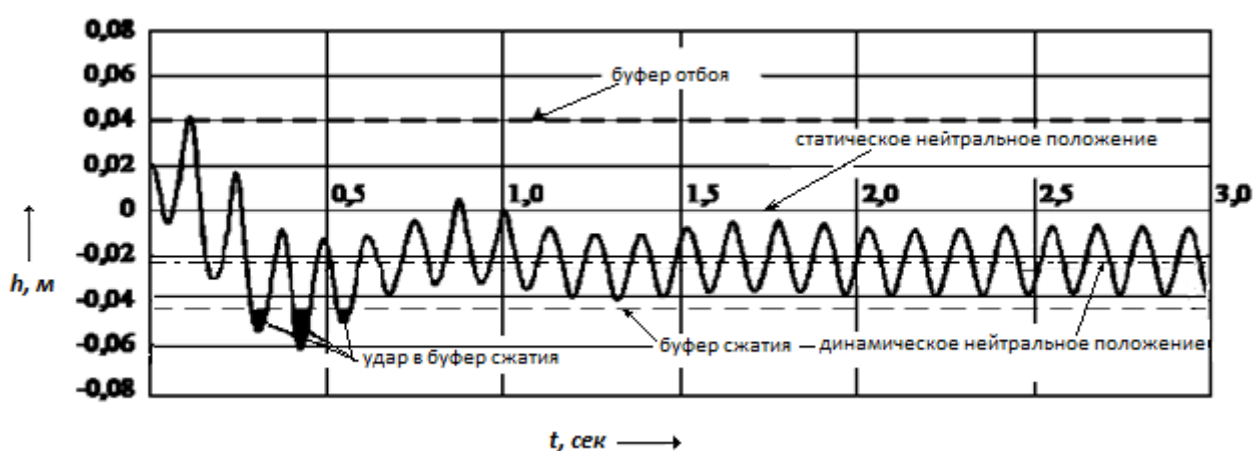
Рисунок 3.8 – Процесс колебания точки крепления пневмопружины к раме тележки
