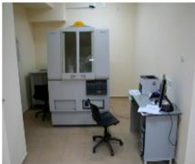
Рисунок 7 – Рентгеновский дифрактометр X'pert MPD PRO
