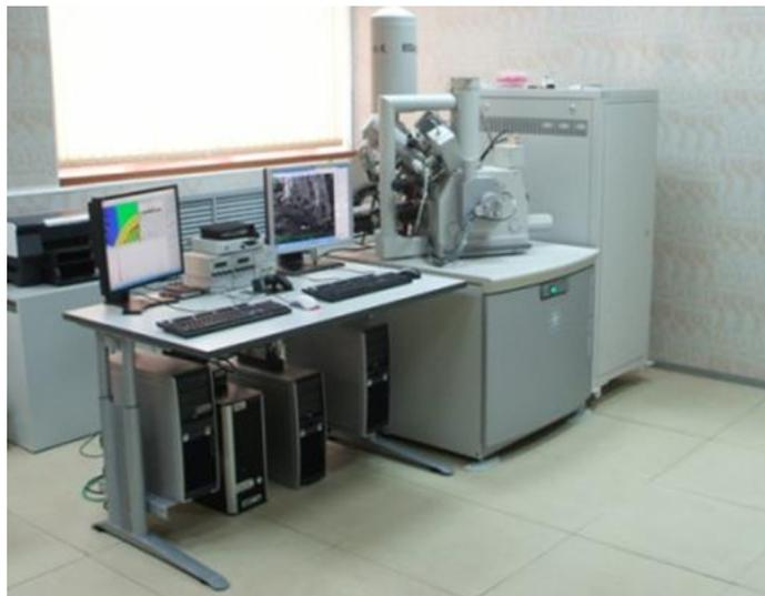
Рисунок 6 – Электронный сканирующий микроскоп Quanta 200i 3D
