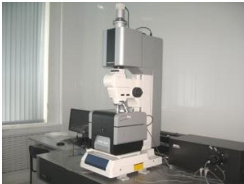
Рисунок 8 – Спектрометр Solver Spectrum
