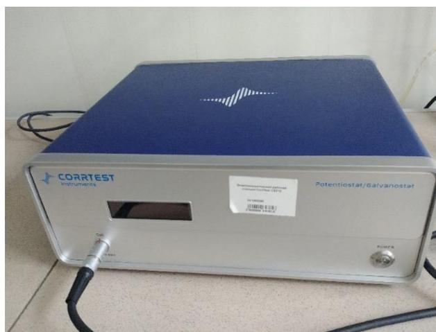
Рисунок 11 – Одноканальный потенциостат/гальваностат Corrtest CS310
