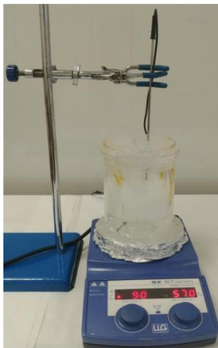
Рисунок 4 – Низкотемпературный гидротермальный синтез оксида цинка
