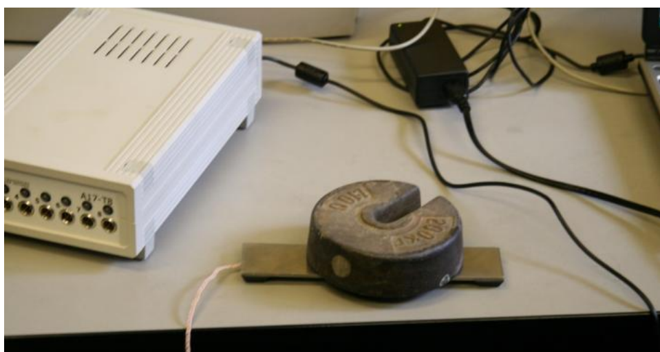
Сурет 3.16 - Статикалық эталондық салмақ жүктемесін қолдану арқылы жүктеме жасушаларының көрсеткіштерін тексерудің тікелей әдісі
