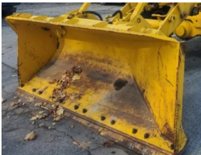
Сурет 1.19 - Clark компаниясының қайырмасының бір жағы қиғаш ожау тәрізді қайырма
