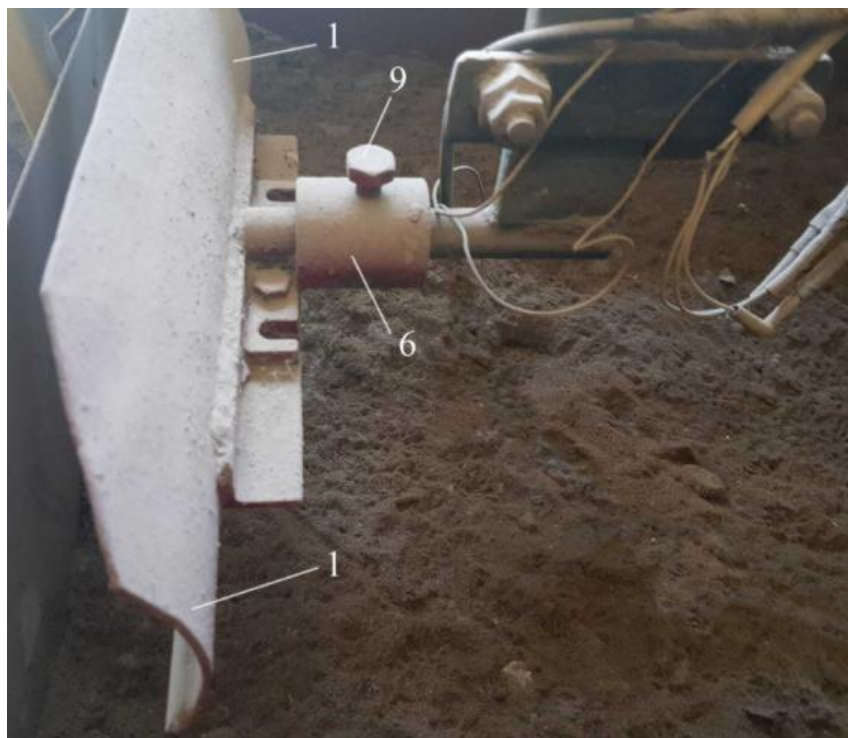
Сурет 3.10 - Айналмалы емес қайырма моделінің стендке бекіту
