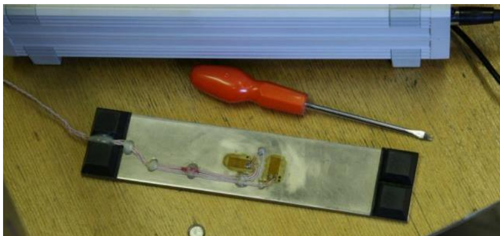
Сурет 3.14 - Тензометриялық панельге жүктеме ұяшықтарын жапсыру схемасы
