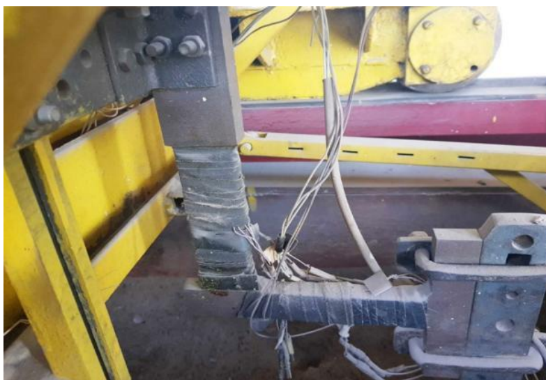
Сурет 3.11 - Тартқыш арбаның жүзі мен тірек панеліне тензозвезді (тензобалканы) монтаждау
