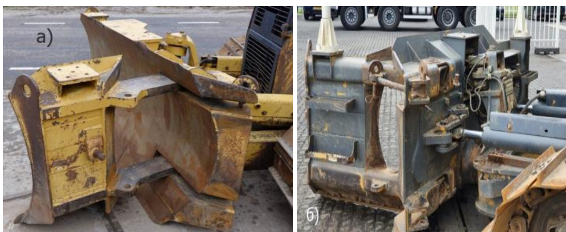
Сурет 1.24 - Қайырманың пішінін өзгертуге мүмкіндік беретін Caterpillar бульдозер қайырмасының артикуляцияланған және гидравликалық басқарылатын бөлімі
