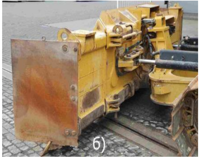
Сурет 1.26 - Негізгі қайырмаға орнатылған көлденең тақтайшалары бар бульдозер қайырмасының бүйірлік кеңейткіштері
