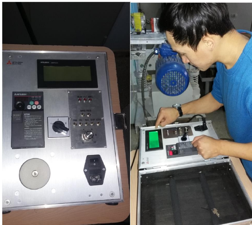
Сурет 3.15 - FR-E700 Mitsubishi Electric жиілікті түрлендіргіш арқылы дебалансты біліктің айналым жиілігін өзгерту
