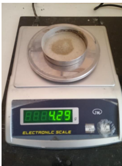
Сурет 3.14 - Ұнтақталатын (ұсақталатын) материалдың массасын өлшеу [54,6.76]
