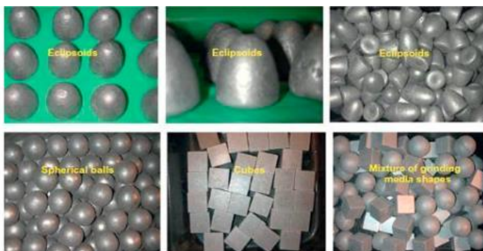
Сурет 1.13 - Ұнтақтау денелерінің әр түрлі пішіндері [52,6.42]
