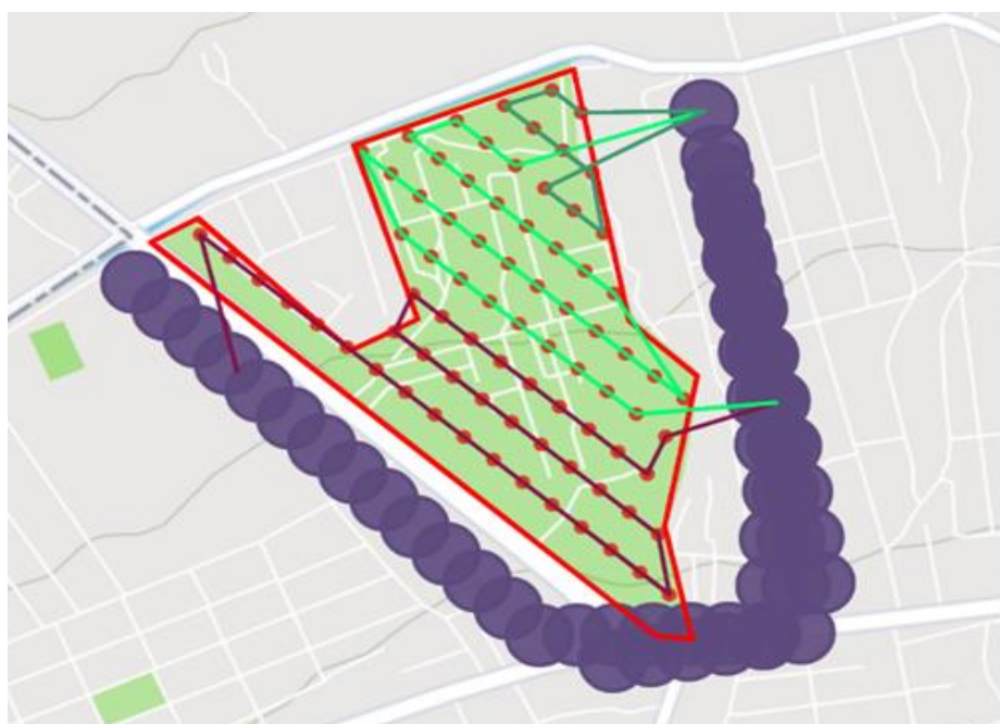
Рисунок 20 - Маршрут облета поля "Сложной" формы с движением аппарата. Разные цвета линий обозначают отдельные циклы взлета и посадки
