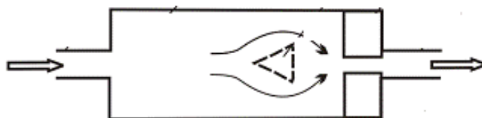
Рисунок 3.3 – Возникновение гидродинамической активация
