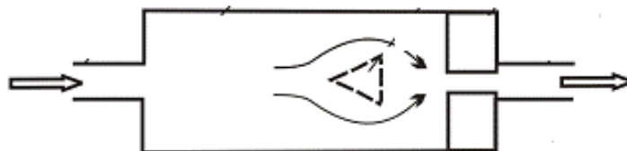
Рисунок 3.3 – Возникновение гидродинамической активация
