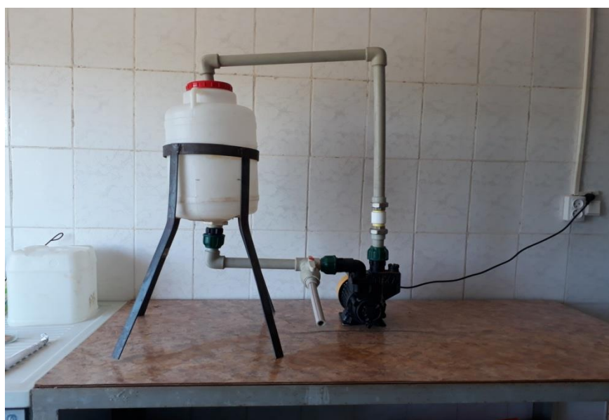
Рисунок 3.6 – Лабораторная установка для активации раствора
