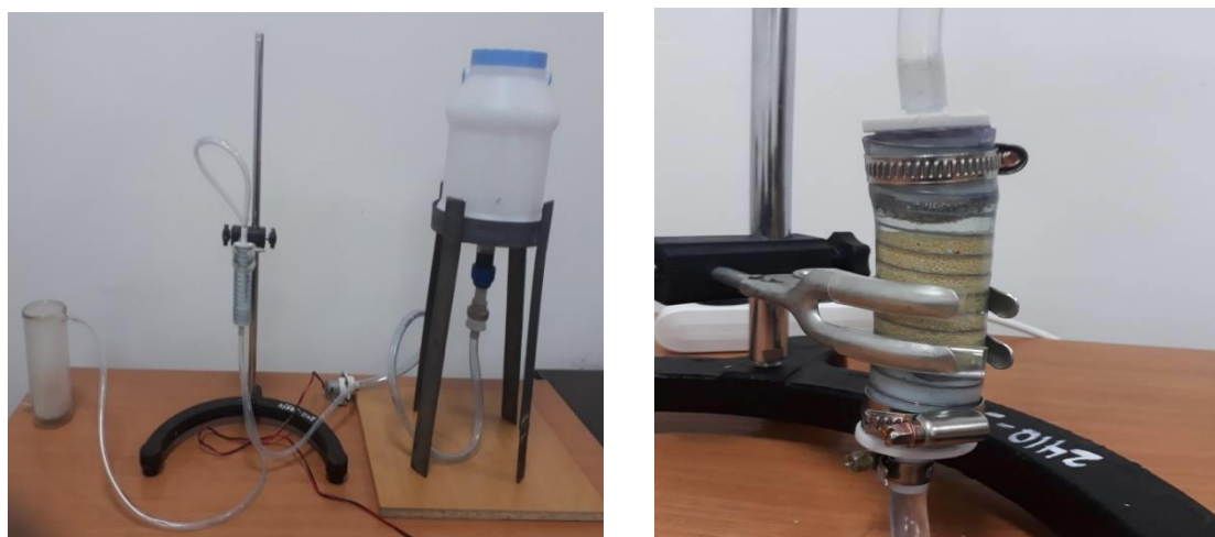
Рисунок 3.4 – Лабораторная установка по денитрации смолы
