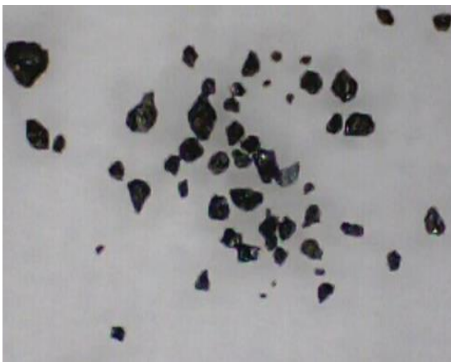
Сурет 4.18 – Колумбит дәндерінің орталық бөлігі ниобиймен, ал перифериясы танталмен байытылған. Фотосурет iPhone 14 ұялы телефон арқылы түсірілген
