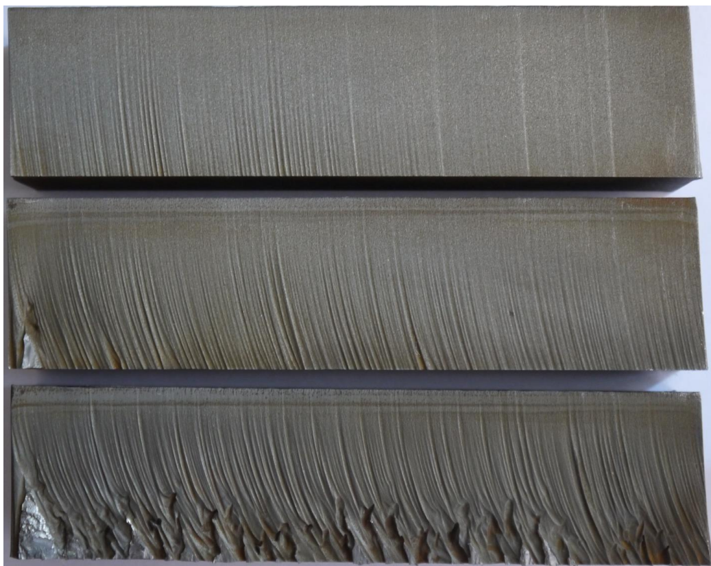
3.25-сурет – Кесу үлгілері (шынықтырылғанан кейінгі тетік)
