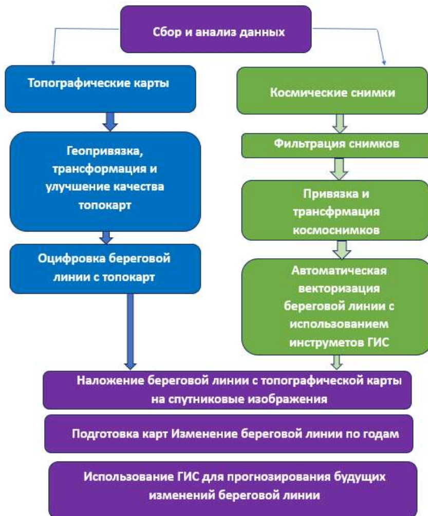
Рисунок 2.5 - Технологическая схема картирования береговой линии по данным ДЗЗ
