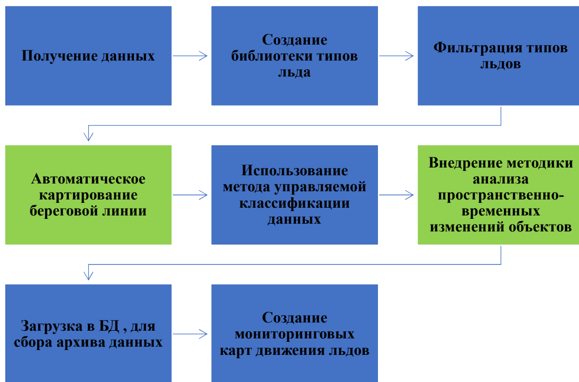
Рисунок 2.2 - Предложенная технологическая схема мониторинга движения морского льда
