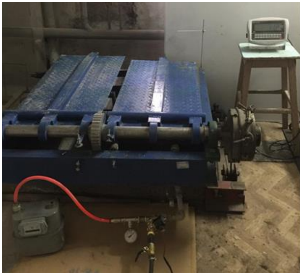
Сурет 3.5– Тік тетігі бар пышақ түріндегі ПКІҚҚ тірегінің физикалық үлгісі
