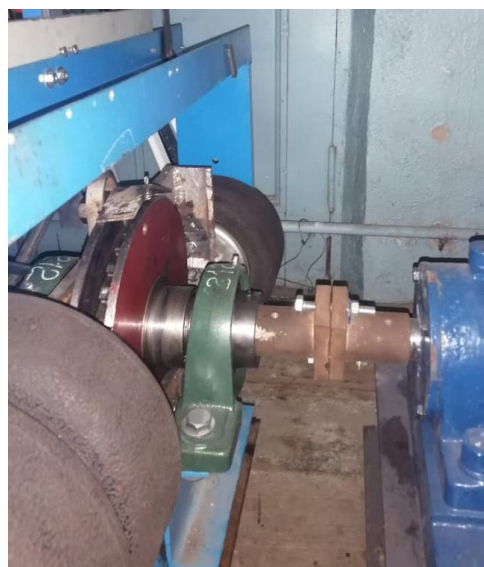
Сурет 3.2 – Іске қосу және қосалқы жетекті қосу қондырғысы
