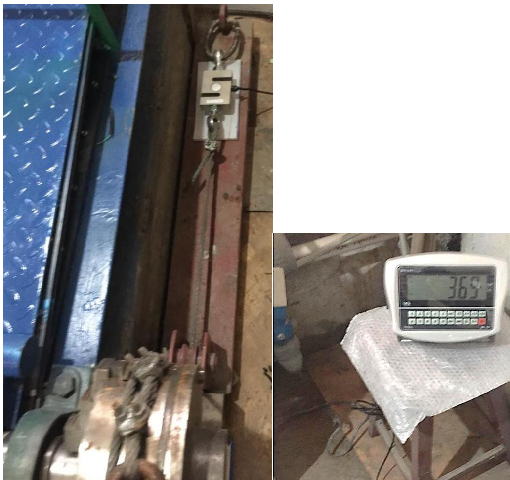
Сурет 4.5 – Жетек шығаратын моментті анықтауға арналған қондырма
