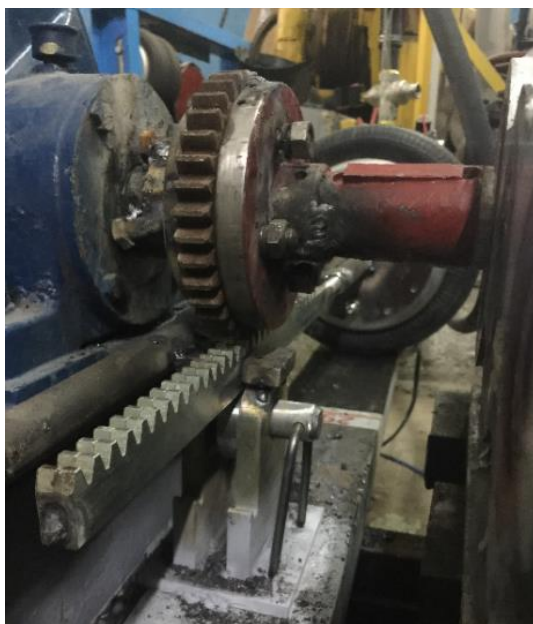
Сурет 3.9 – Тіректі көтеруге және түсіруге арналған блок
