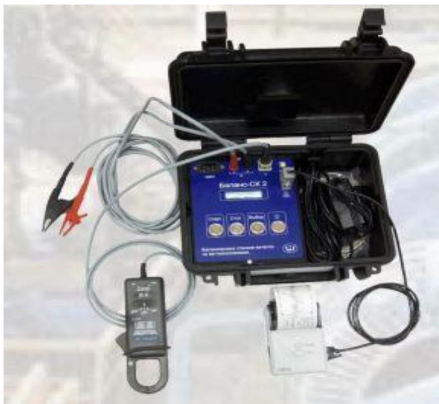
Сурет 3.30 – "Баланс-СК2" балансирлеу құрылғысы
