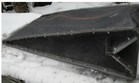
Сурет 4.3 – Үрленген күйдегі айналмалы әрекет камерасы
