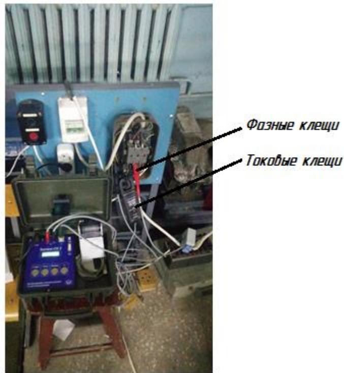
Сурет 3.31 – Баланс-СК2 қосылу схемасына
