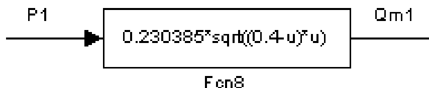
Сурет 2.11 – Пневмобаллон қуысындағы аэромеханиканың s моделі
