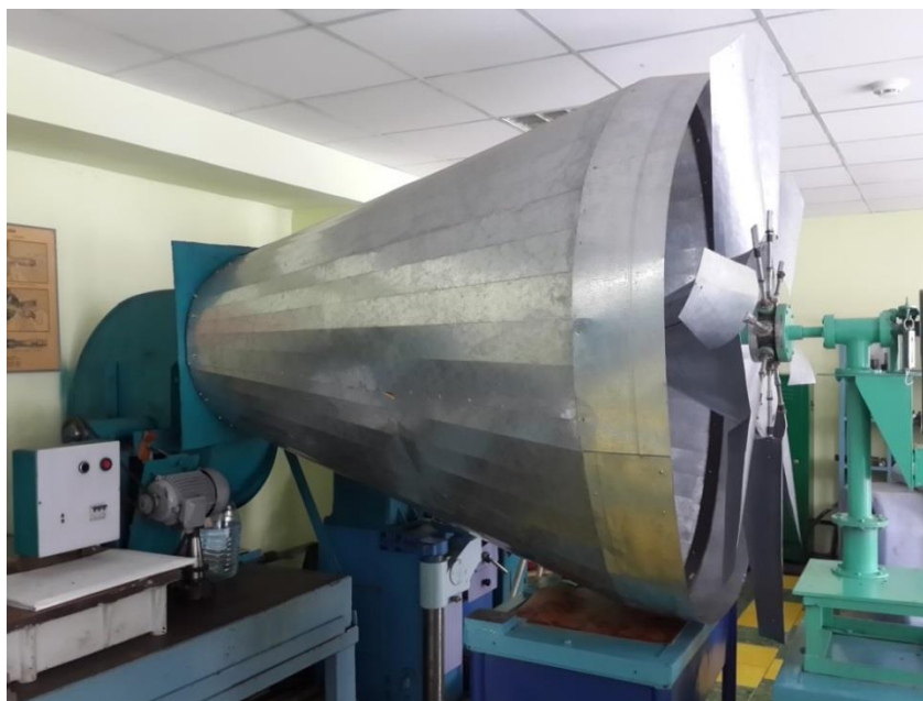
Рисунок 37 – Аэродинамическая труба диаметром 1450 мм (вид сбоку)
