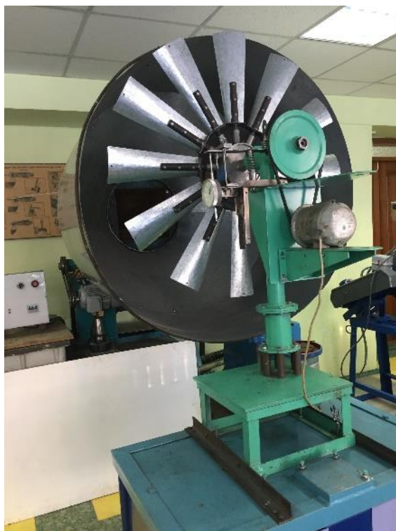
Рисунок 20 – Аэродинамический стенд с диаметром аэродинамической трубы 620 мм
