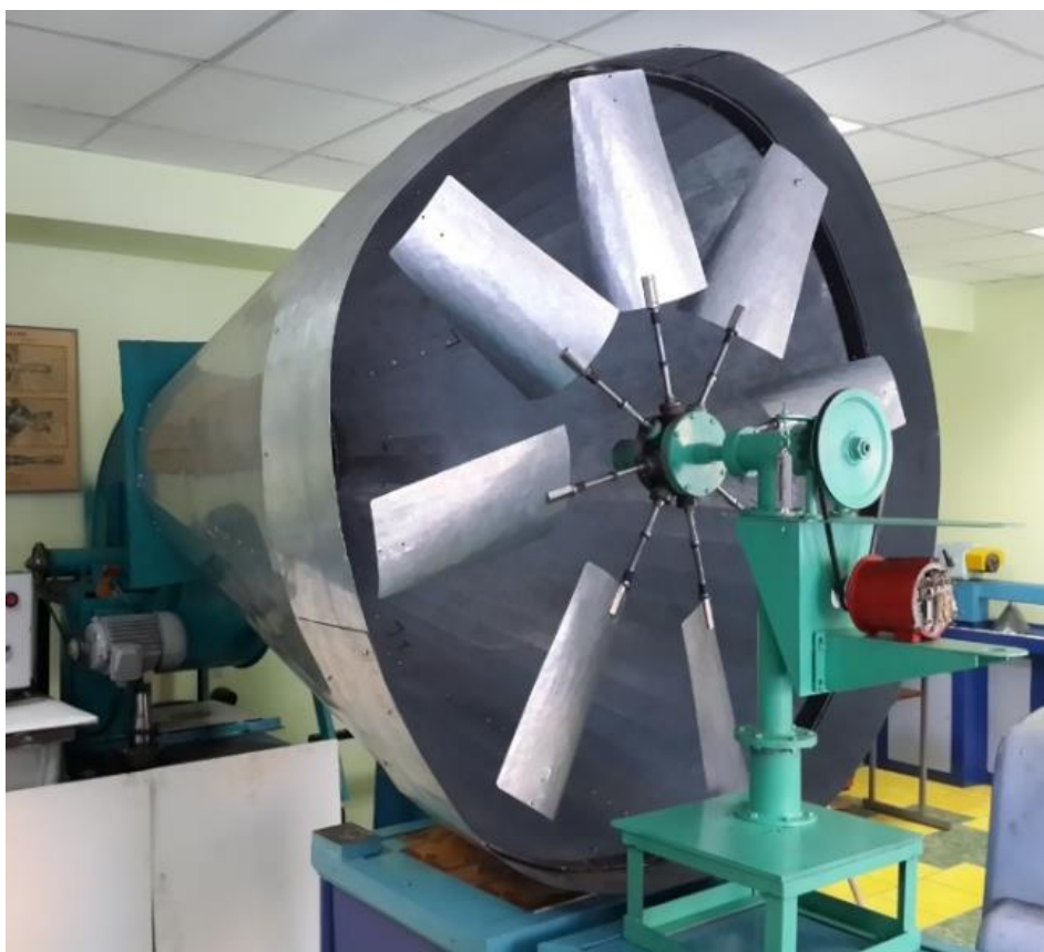
Рисунок 21 – Аэродинамический стенд, с диаметром аэродинамической трубы 1450 мм
