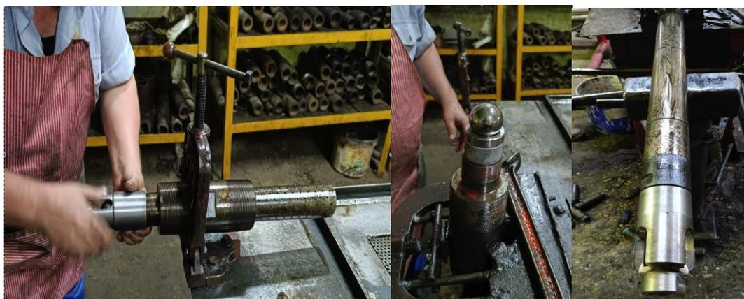
Рисунок 4.2 – Установка «турбулизаторов» и удлиненных корпусов
