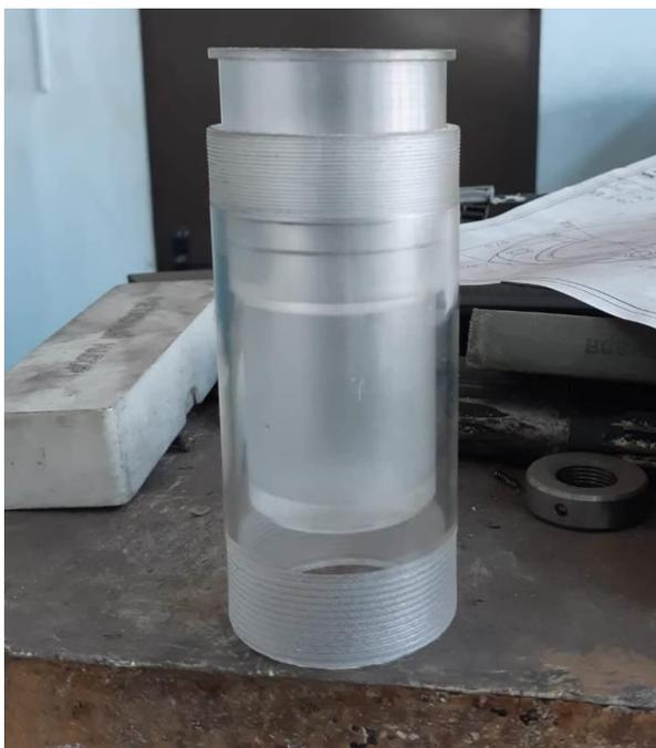
Рисунок 3.8 – Удлиненный корпус клапана изготовленный из оргстекла
