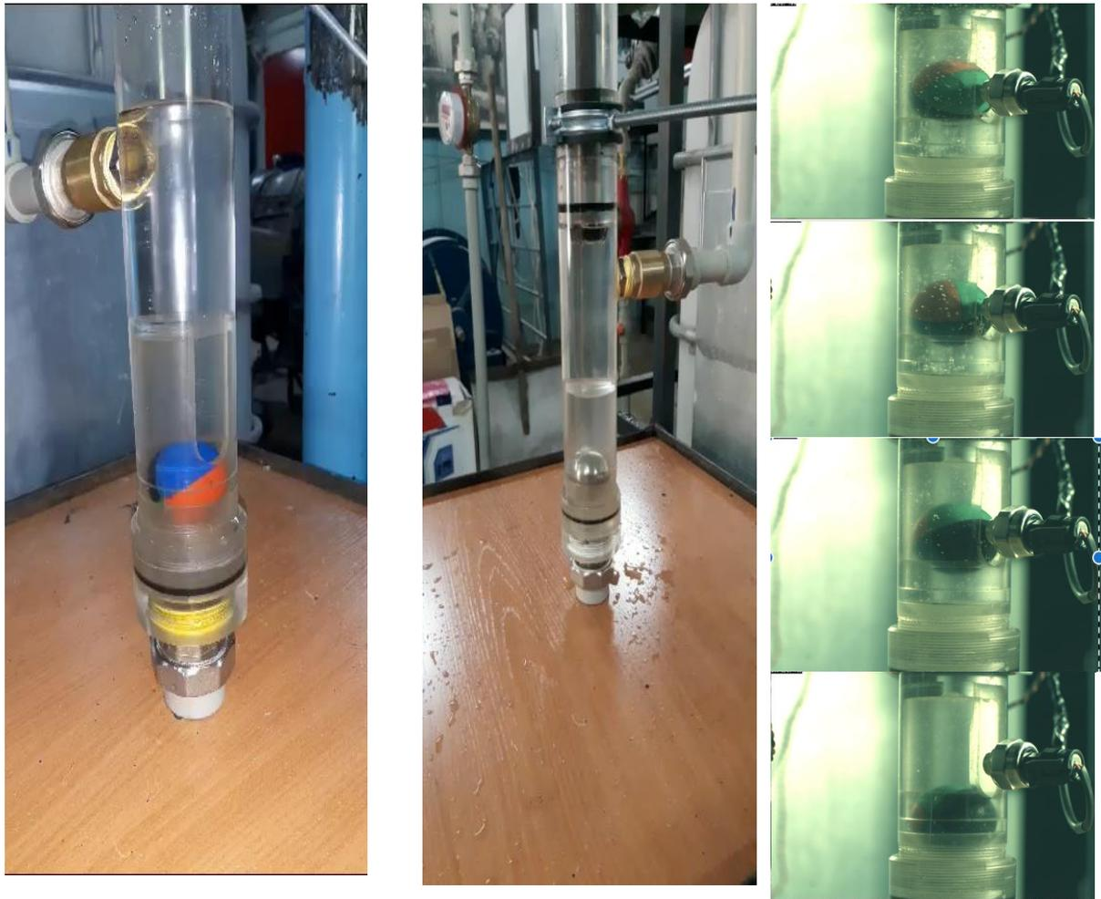
Рисунок 3.18 – Момент вращения запорного элемента клапана – шарика с установленным «турбулизатором» с винтовой пластиной 7,5 мм и снимки полученные с камеры EVERCAM-1000-8-M.
