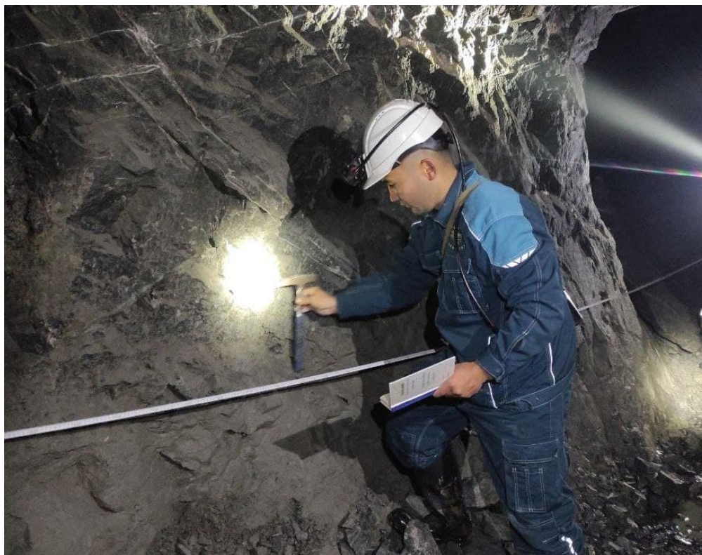
Рисунок 42 – Натурально-визуальный метод изучения трещиноватости
