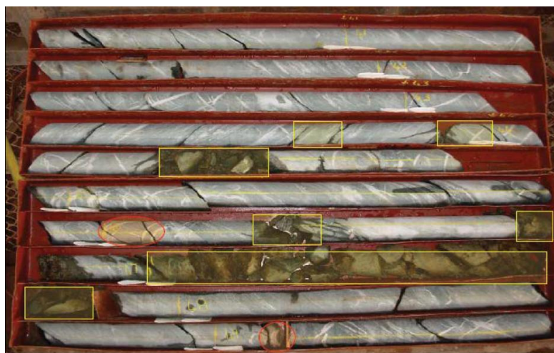
Рисунок 51 – Пример определения ППП (RQD)
