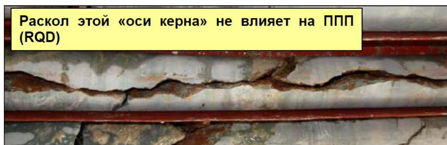
Рисунок 47 – Открытые трещины, ориентированные параллельно оси керна
