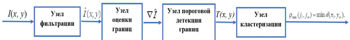
Рисунок 4.1 – Система обнаружения внутритрубного дефекта
