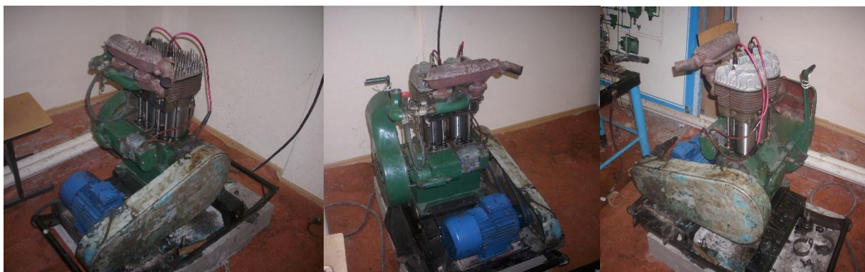
Сурет 3.2 – Ыстық сынақтарды жүргізуге арналған толық жинақталған тәжірибелік қозғалтқыш
