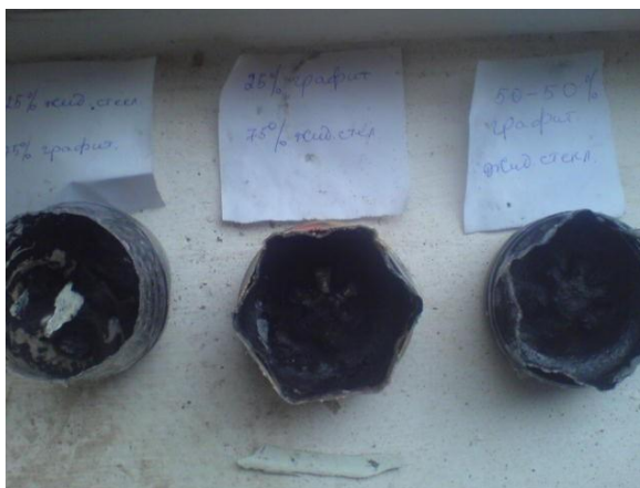
Сурет 3.4 – Графит пастасын сұйық шынымен байланыстырушы ретінде дайындау процесі (графит пен байланыстырушының пайыздық (%) арақатынасы бойынша үш түрлі құрам дайындалды: 25/75; 50/50; 75/25).
