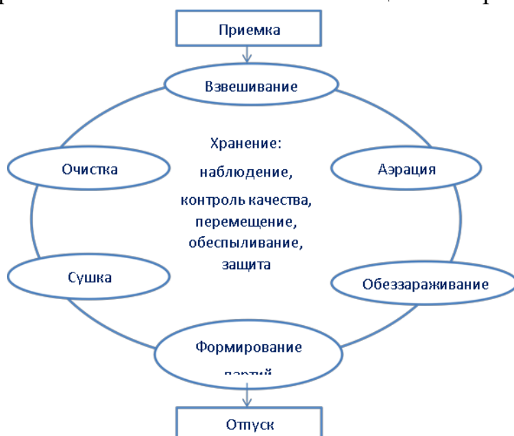
Рисунок 7 – Основные операции с зерном на зернохранилищах
