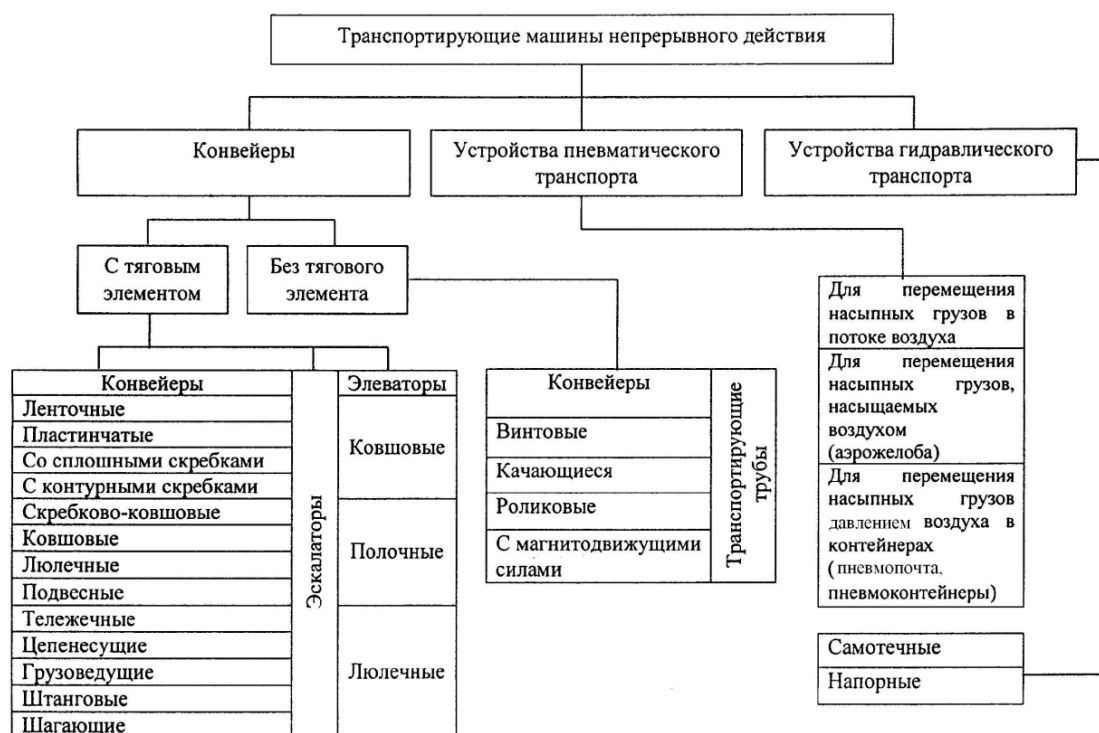
Рисунок 6. – Общая классификация транспортеров
