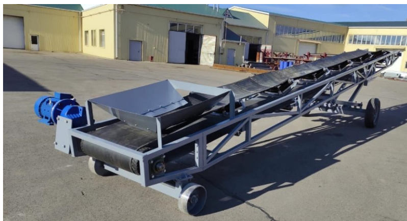
Рисунок 32-Экспериментальные транспортер с углом наклона боковых роликов \alpha_p = 20^\circ .
