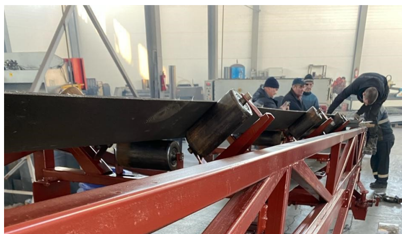
Рисунок 34- Конвейер с экспериментальными роликами с углом наклона боковых роликов \alpha_p = 45^\circ
