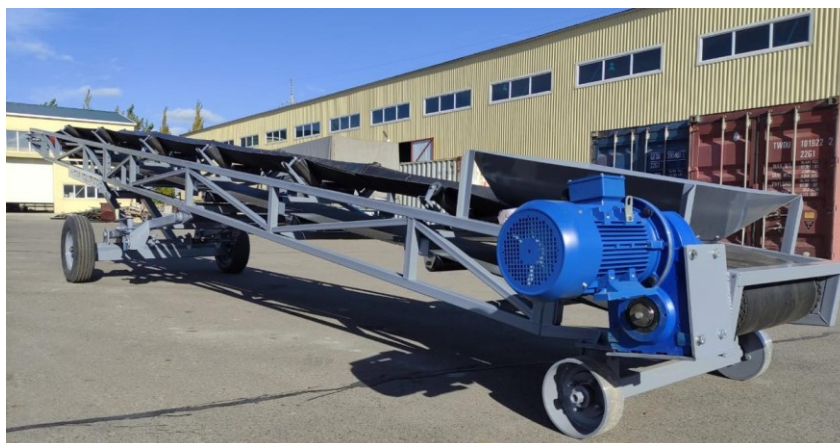
Рисунок 33-Экспериментальные транспортер с углом наклона боковых роликов \alpha_p = 30^\circ .
