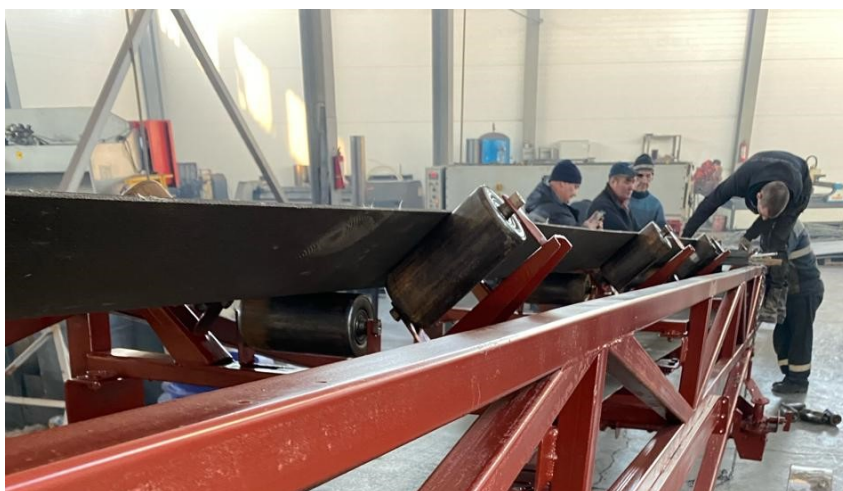
Рисунок 45- Конвейер с экспериментальными роликами с углом наклона боковых роликов \alpha_p = 45^\circ
