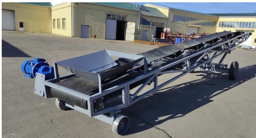
Рисунок 43-Экспериментальные транспортер с углом наклона боковых роликов \alpha_p = 20^\circ
