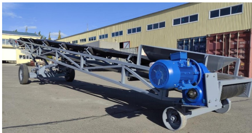
Рисунок 44-Экспериментальные транспортер с углом наклона боковых роликов \alpha_p = 30^\circ
