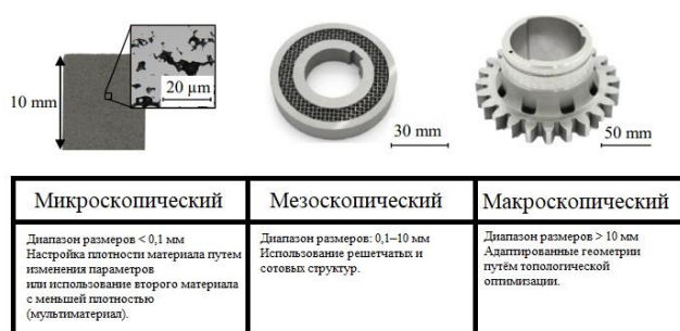
Сурет 2.3 – Лазерлік балқыту процесіндегі жеңілдетілген конструкциялардың өлшемдік деңгейлері
