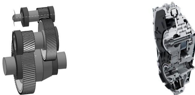
Сурет 1.6 – Екі сатылы цилиндрлік редуктордың шамамен бейнесі (сол жақта) және планетарлық пен цилиндрлік редукторлардың комбинациясы (оң жақта)
