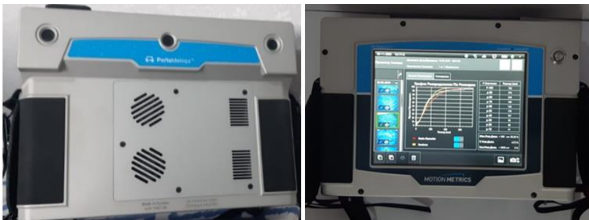
Рисунок 3.15 - Прибор для измерения фрагментации взорванной горной массы «PortaMetrics» серийный номер PM2136
