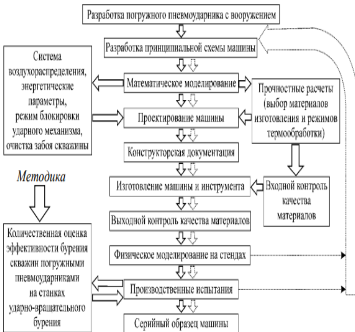
Рисунок 4.1 - Схема повышения эффективности бурения скважин с расширением их диаметра
