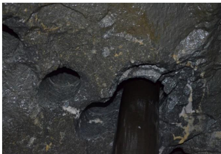
Рисунок 3.7 - Образование врубовой полости бурением сопряженных скважин
