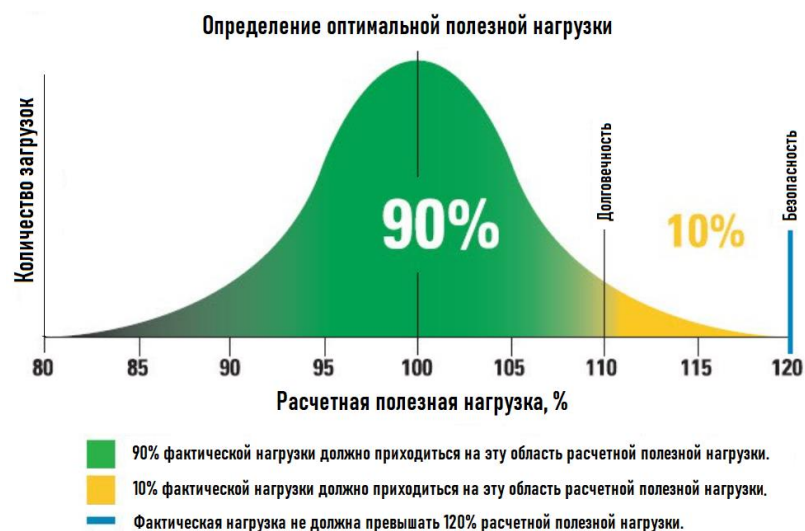
Рисунок 3.18 - Правило загрузок 10/10/20 оборудования «Caterpillar»
