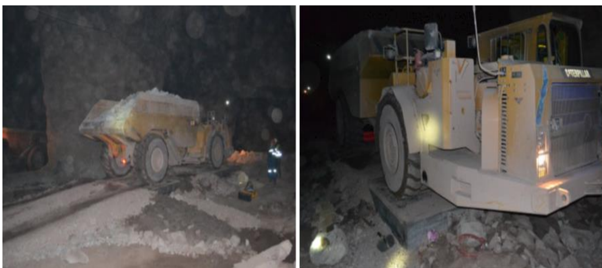
Рисунок 3.20 - Процесс взвешивания подземного самосвала CAT AD30 в подземных условиях
