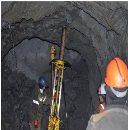
Рисунок 3.6 – специальное приспособление для бурения скважин диаметром 65 мм и 110 мм.
