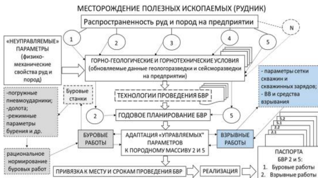
Рисунок 4.2 - Схема повышения энергоэффективности добычи полезных ископаемых в рудниках при бурении скважин с расширением их диаметра
