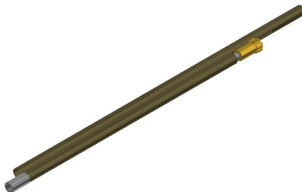
Рисунок 3.11 – Основное приспособление для бурения сопряженных скважин для первого и второго варианта
