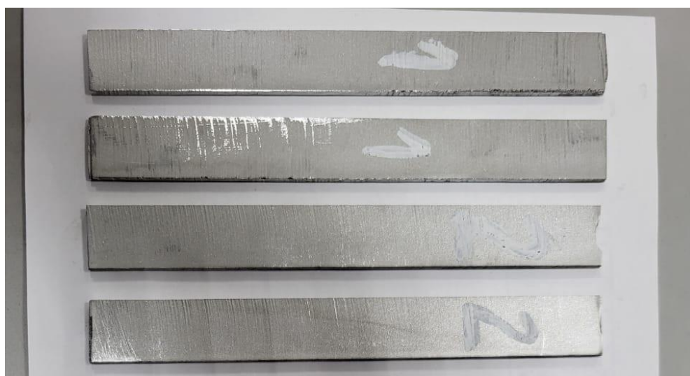
Сурет 4.5 – Созылу сынақтарына арналған EN AW-6082 алюминий қорытпасынан дайындалған үлгілер: 1 – илемдеуге дейінгі бастапқы дайындамадан; 2 – радиалды-ығыстыра илемдеуден кейінгі шыбықтан.
