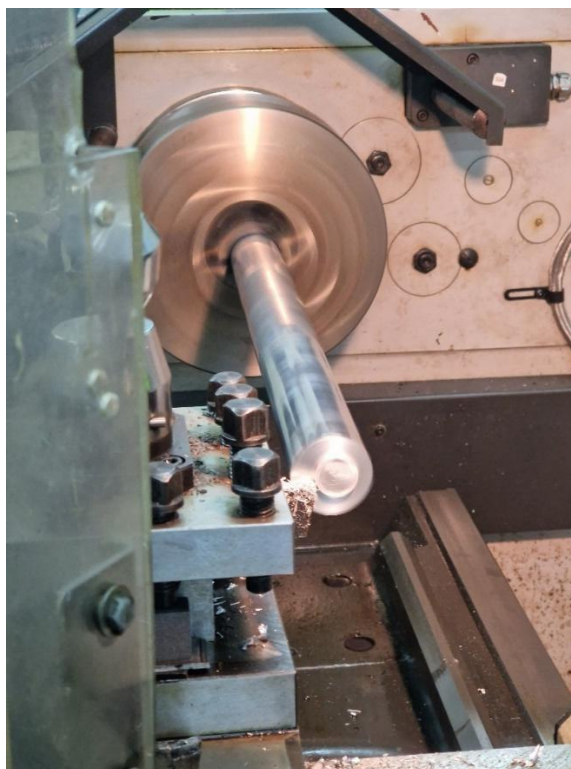
Сурет 3.1 – Жону білдегінде EN AW-6082 алюминий қорытпасынан дайындамаларды өңдеу
