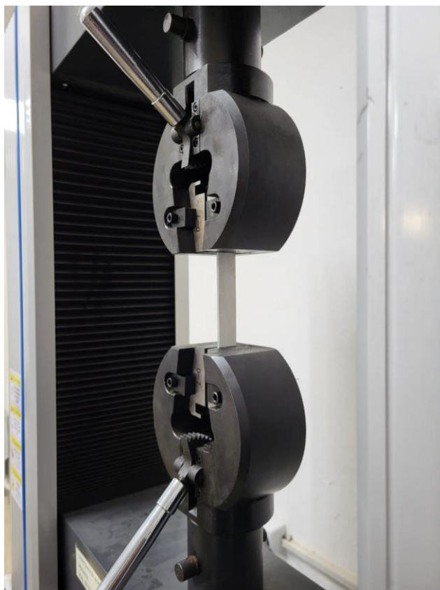
Сурет 4.7 – UTM-E100 сынақ машинасындағы пропорционалды жазық үлгіні бекіту
