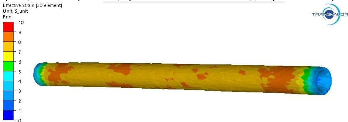
Сурет 3.27 – Радиалды-ығыстыра илемдеудің үшінші өтімінен кейінгі (35–30 мм) шыбық беті бойынша пластикалық деформация интенсивтілігінің кеңістіктік таралуы
