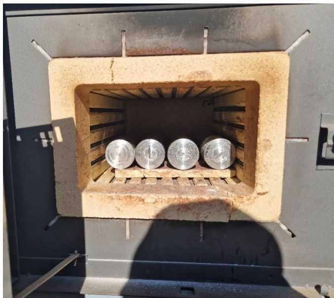
Сурет 3.3 – Илемдеуді жүргізер алдындағы дайындамаларды муфель пешінде 350 °С температураға дейін қыздыру процесі
