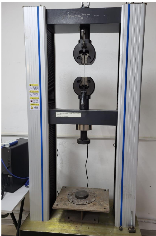
Сурет 4.6 – UTM-E100 сынақ қондырғысы дайындаманы созу процесінде
