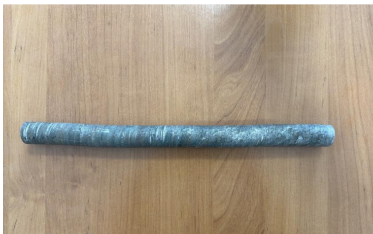
Сурет 3.7 – Радиалды-ығыстыра илемдеу орнағында үшінші өтуден кейінгі EN AW-6082 алюминий қорытпасынан алынған шыбықтың сыртқы көрінісі
