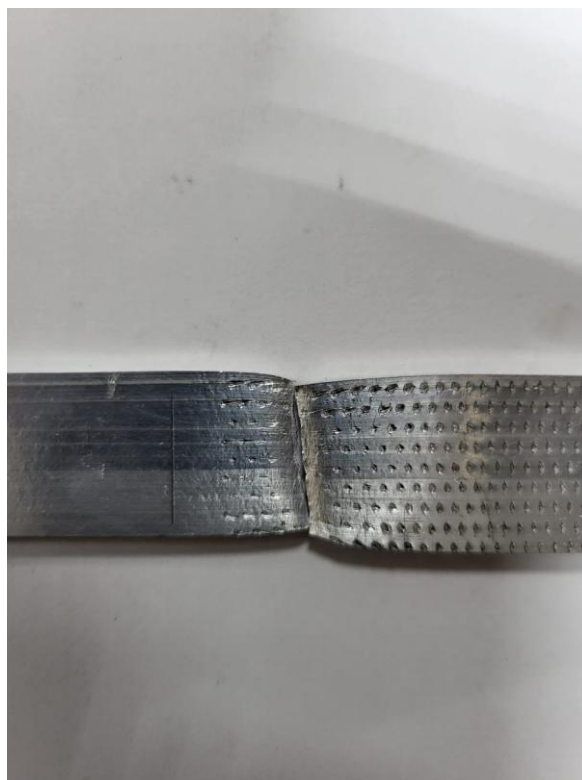
Сурет 4.10 – Деформация аймағында үзіліске ұшыраған үлгі
