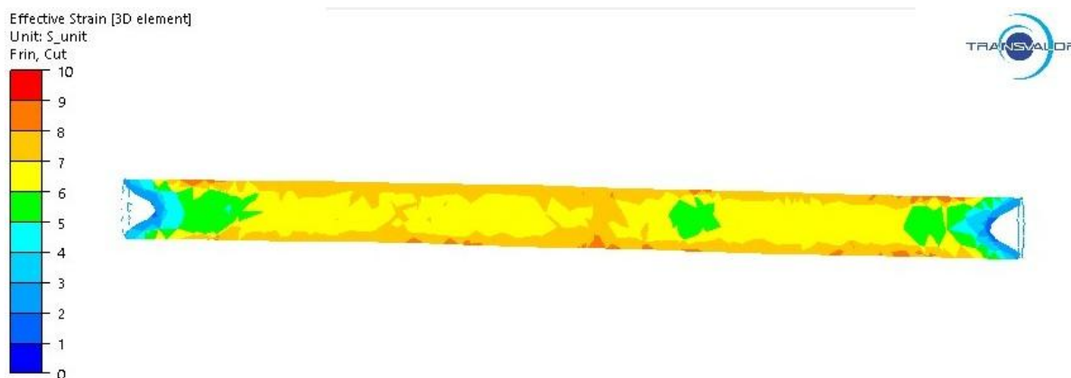
Сурет 3.28 – Радиалды-ығыстыра илемдеудің үшінші өтімінен кейінгі (35–30 мм) шыбықтың бойлық қимасындағы пластикалық деформация интенсивтілігінің таралуы
