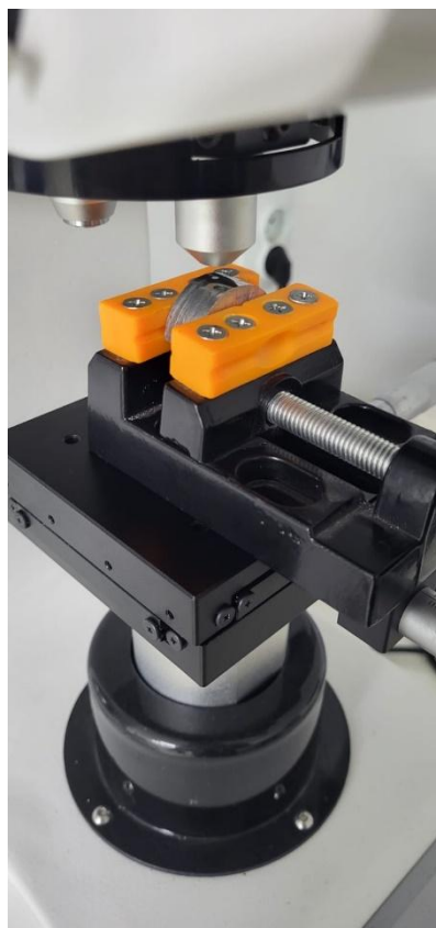
Сурет 3.11 – EN-AW 6082 алюминий қорытпасынан дайындалған үлгінің Виккерс әдісі бойынша өлшеу кезінде микрокаттылық өлшегіштің қысқыш құрылғысында орналасуы.
