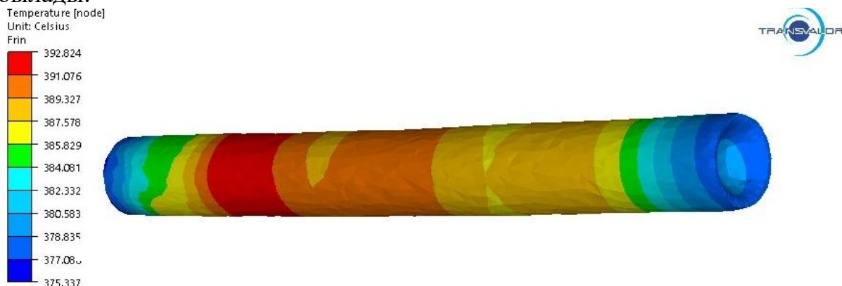
Сурет 3.15 – Радиалды-ығыстыра илемдеудің екінші өтімінен кейінгі (40–35 мм) шыбық беті бойынша температураның кеңістіктік таралуы
