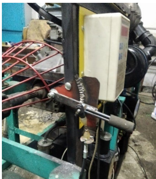
Рисунок 51 – Рычажное устройство с точной градацией установочного угла для фиксации скоростного режима
