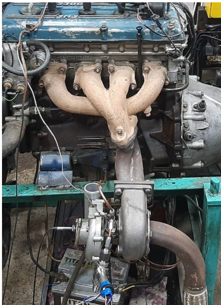
Рисунок 38 – Турбокомпрессор K27-145 (Чехия), работающий на выхлопных газах двигателя
