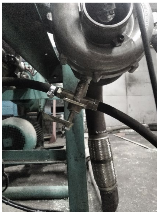
Рисунок 49 – Трёхходовой кран с расходомером масла на сливе турбокомпрессора и термопарой для контроля мгновенной температуры масла на выходе из подшипника ТКР
