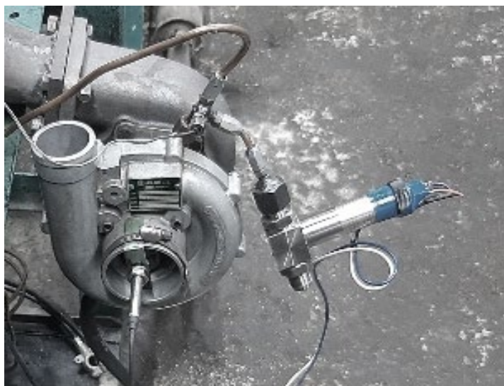
Рисунок 47 – Компактный дифференциальный датчик давления APZ 3020
