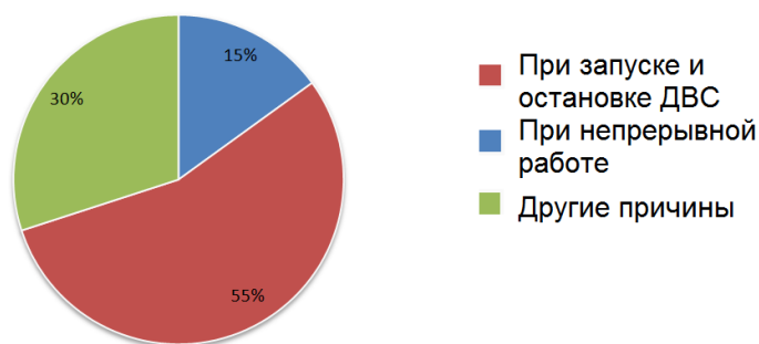
Рисунок 5 – Распределение отказов ТКР в зависимости от режима работы
