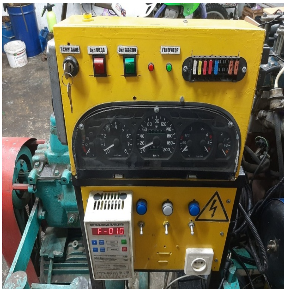
Рисунок 39 – Стандартная система управления исследовательского стенда, включающая щиток приборов, ЭБУ, блок предохранителей и замок зажигания
