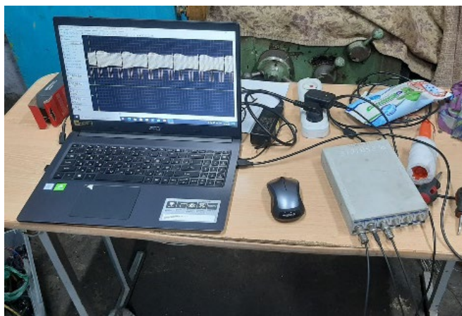
Рисунок 42 – Цифровой осциллограф USB Autoscope III (Осциллограф Постоловского) при проведении измерений рабочих параметров
