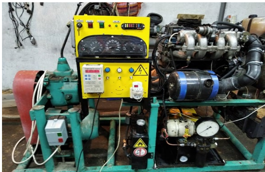
Рисунок 36 – Экспериментальная установка, выполненная на основе двигателя с турбокомпрессором K27-145 (производство Strakonice, Чехия)
