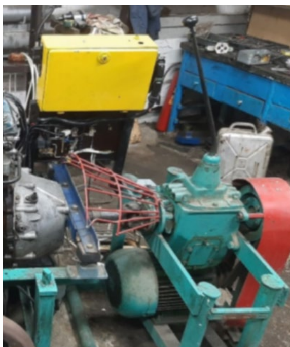
Рисунок 37 – Электродвигатель мощностью 5,5 кВт, соединённый с четырёхступенчатой коробкой передач ГАЗ-52 посредством ременной передачи
