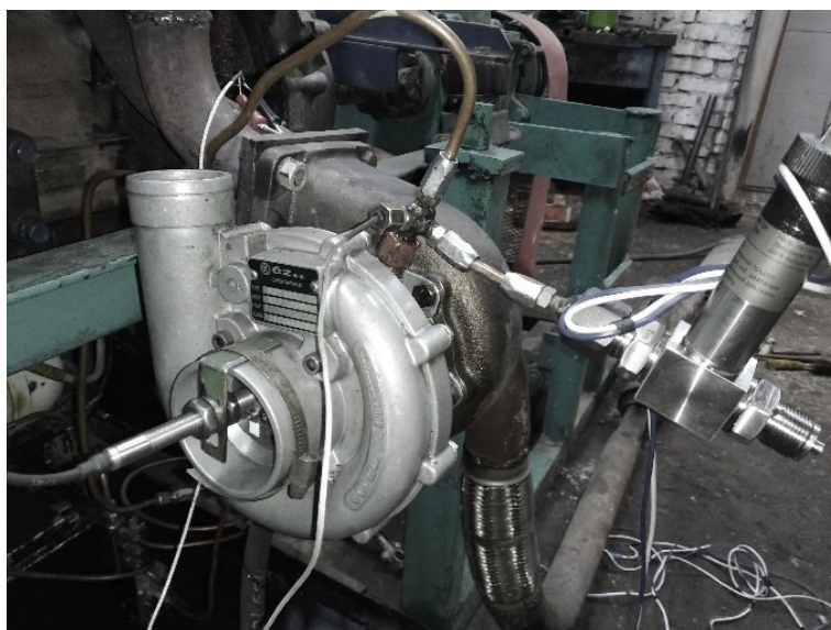
Рисунок 48 – Тройной разветвитель с подключёнными элементами: 1 – подача масла сверху от маслостанции или гидроаккумулятора; 2 – боковой штуцер с датчиком дифференциального давления APZ 3020; 3 – фронтальный штуцер с установленной термопарой
