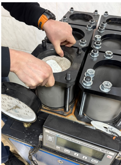
Рисунок 25 - Испытания бетонных образцов на водопроницаемость
