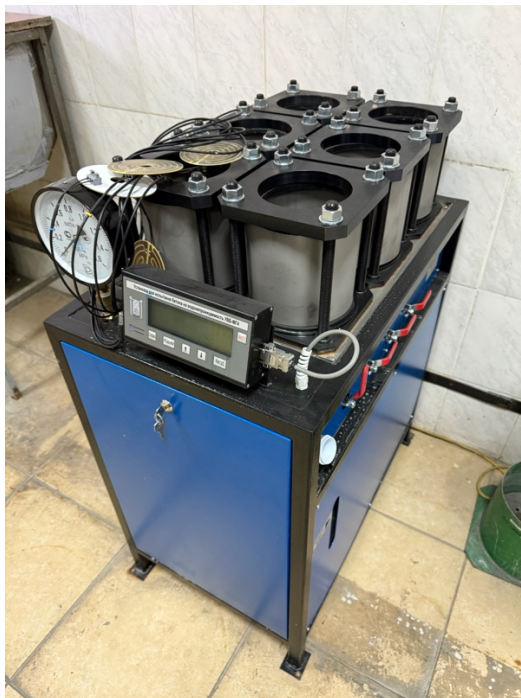
Рисунок 8 - Установка УВБ-МГ4 для испытаний бетонных образцов на водонепроницаемость
