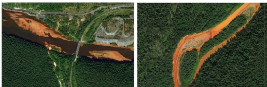
2.5 - Сурет Кизел көмір бассейніндегі қышқылды шахталық сулармен ластанған өзендер мен түптік шөгінділердің жоғары ажыратымдылықтағы спутниктік суреттері (сол жақта — Косьва өзені; оң жақта — Оңтүстік Вильва өзені).
