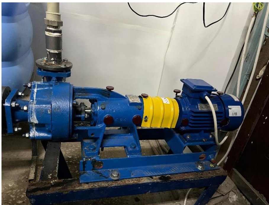
26-сурет. Ортадан тепкіш консоль сорғысының жұмысын бағалауға арналған стенд датчиктері
