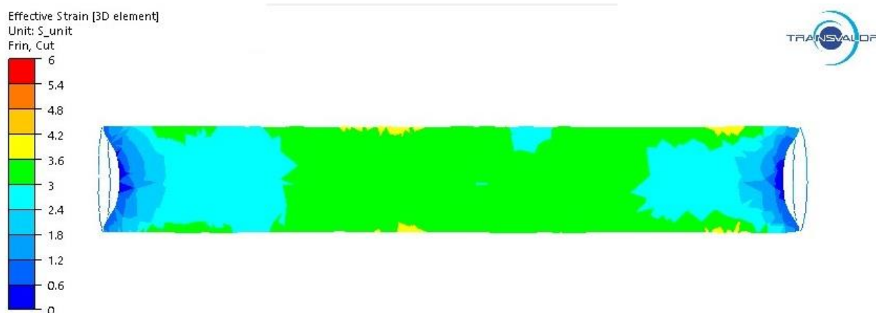
Сурет 3.22 – Радиалды-ығыстыра илемдеудің бірінші өтімінен кейінгі (45–40 мм) шыбықтың бойлық қимасындағы пластикалық деформация интенсивтілігінің таралуы
