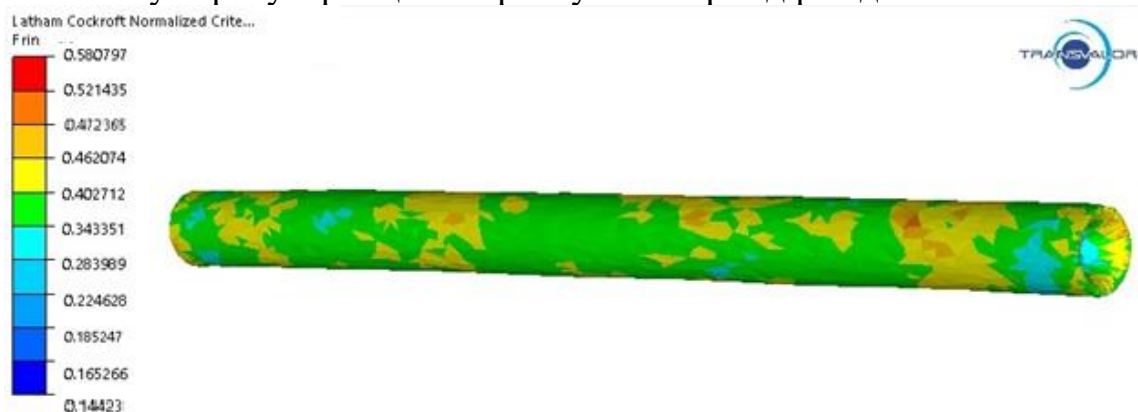
Сурет 3.45 – Радиалды-ығыстыра илемдеудің үшінші өтуінен кейінгі (35–30 мм) шыбық беті бойынша Лэтэм–Кокрофт бұзылу критерийінің кеңістіктік таралуы
