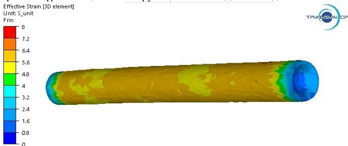
Сурет 3.24 – Радиалды-ығыстыра илемдеудің екінші өтімінен кейінгі (40–35 мм) шыбық беті бойынша пластикалық деформация интенсивтілігінің кеңістіктік таралуы
