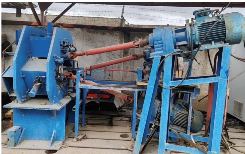
Сурет 3.5 – Экспериментті жүргізу үшін қолданылған радиалды-ығыстыру илемдеу орнағының жалпы көрінісі
