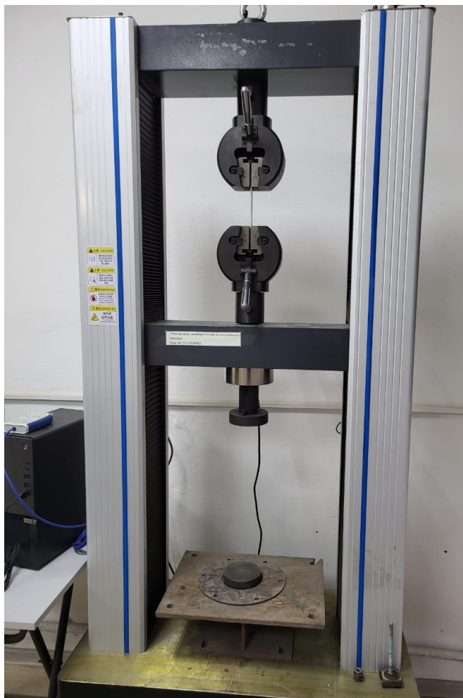
Сурет 4.6 – UTM-E100 сынақ қондырғысы дайындаманы созу процесінде
