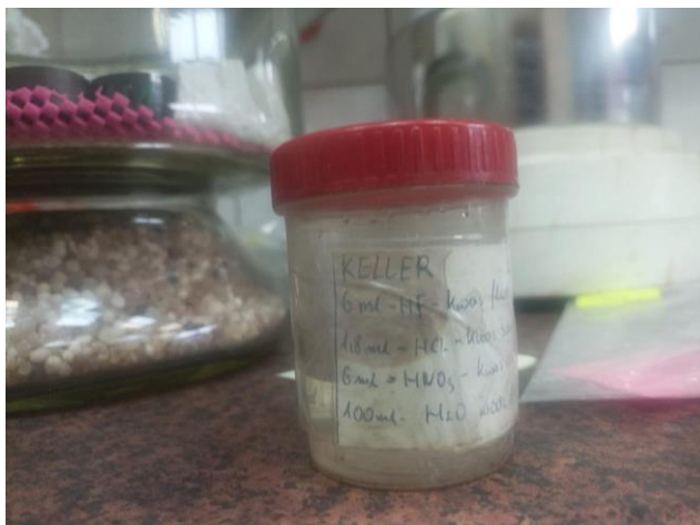
Сурет 3.8 – Металлографиялық даярлаудан кейін EN AW-6082 алюминий қорытпасының микроқұрылымын айқындау үшін қолданылған Келлер реактиві
