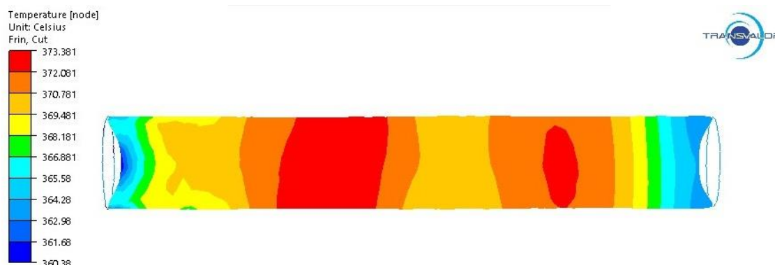
Сурет 3.13 – Радиалды-ығыстыра илемдеудің бірінші өтімінен кейінгі (45–40 мм) шыбықтың бойлық қимасындағы температураның таралуы
