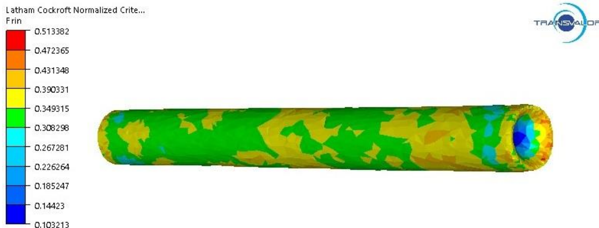
Сурет 3.42 – Радиалды-ығыстыра илемдеудің екінші өтуінен кейінгі (40–35 мм) шыбық беті бойынша Лэтэм–Кокрофт бұзылу критерийінің кеңістіктік таралуы
