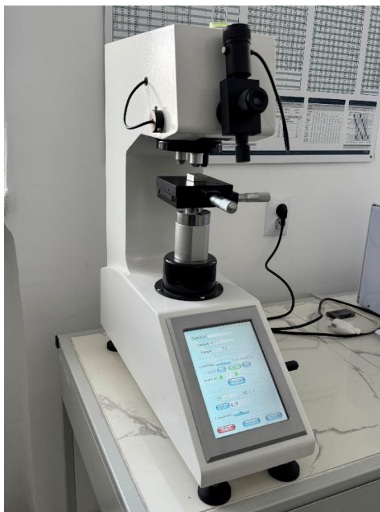
Сурет 3.10 – EN-AW 6082 қорытпасының микрокаттылығын өлшеуге қолданылған сенсорлық экраны бар HLV-1DT Виккерс микрокаттылық өлшегіші
