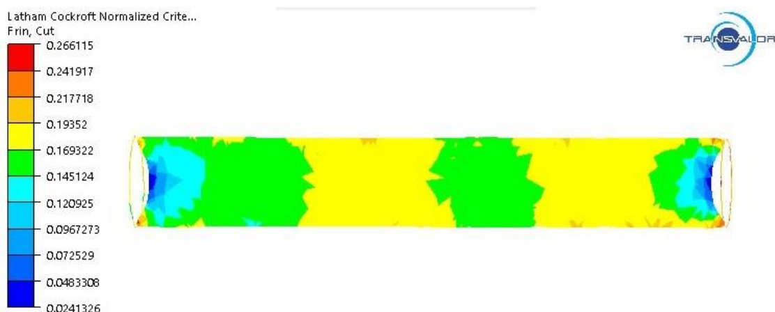
Сурет 3.40 – Радиалды-ығыстыра илемдеудің алғашқы өтуінен кейінгі (45–40 мм) шыбықтың бойлық қимасындағы Лэтэм–Кокрофт бұзылу критерийі мәндерінің таралуы
