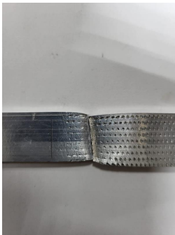
Сурет 4.10 – Деформация аймағында үзіліске ұшыраған үлгі
