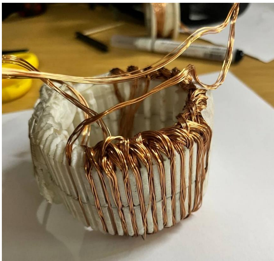
Сурет 17 – Статор орамдарын жасау барысы
