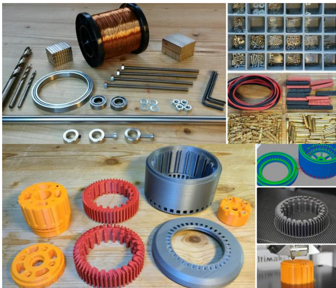
Сурет 13 – Басылған электромотор компоненттері
