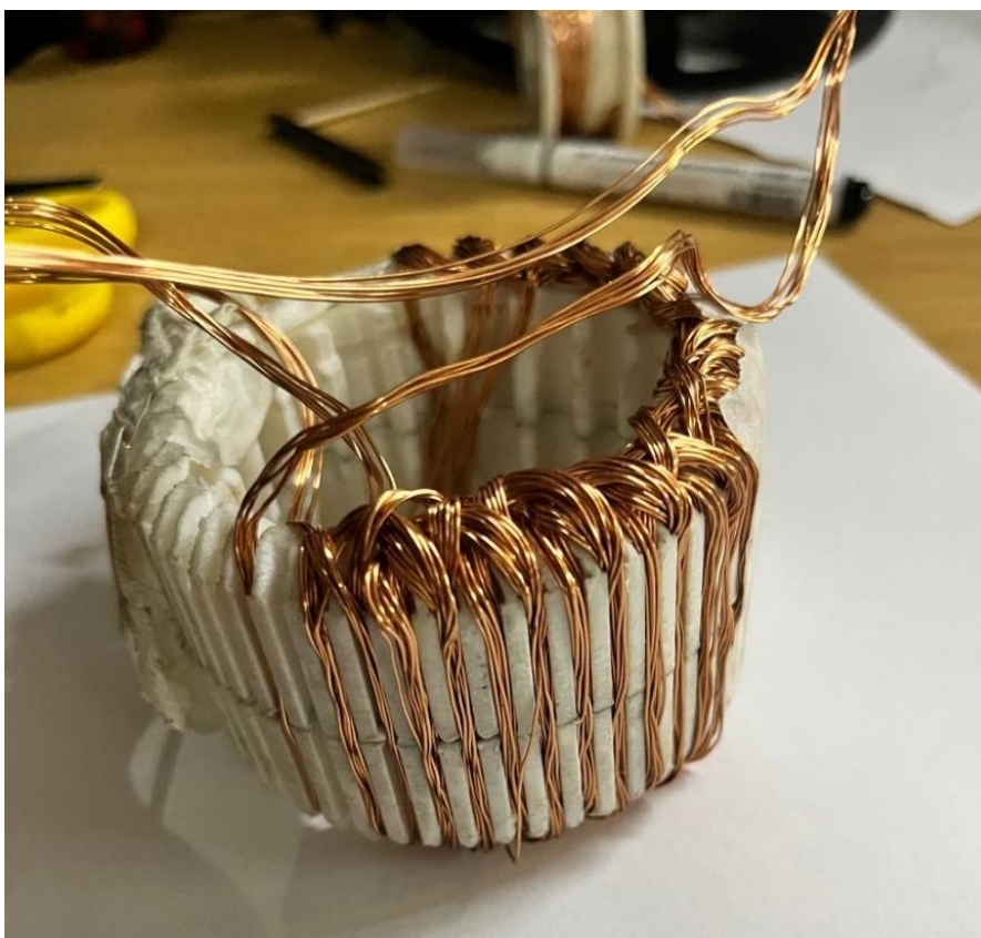
Сурет 17 – Статор орамдарын жасау барысы
