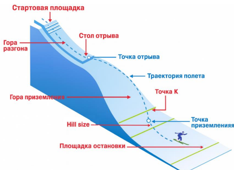
Рисунок 1.5 – Схема устройства лыжного трамплина
