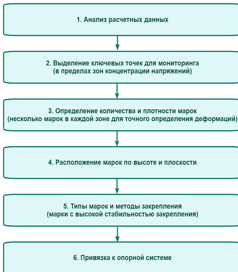
Рисунок 3.3 – Технологическая схема установки контрольных марок на основе расчёта напряжённо-деформированного состояния конструкции
