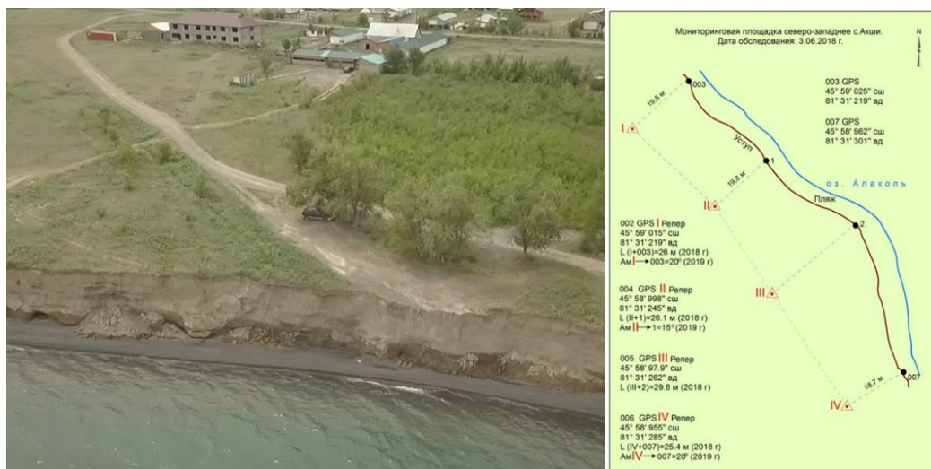
Рисунок 4.3 - Результаты инструментального мониторинга динамики разрушения берегового уступа с. Акши
