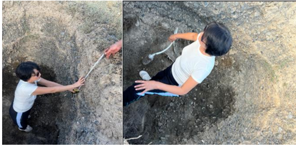
Рисунок 2.19 Наблюдательная скважина, вскрытая в шурфе. (2023г)
