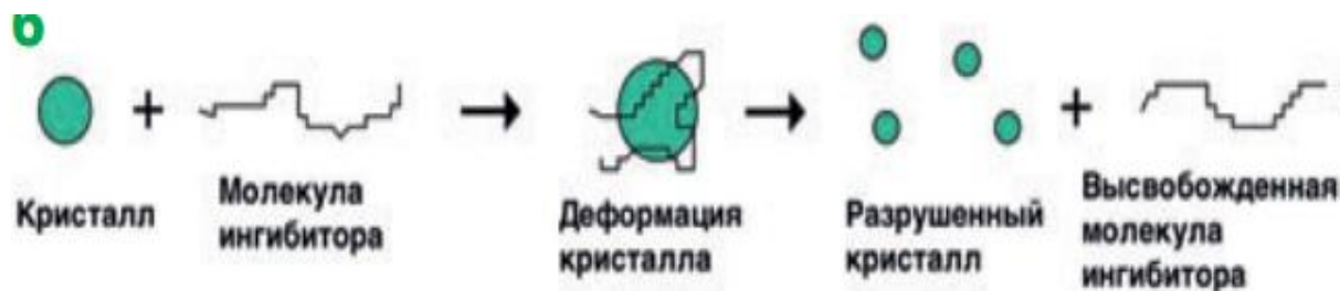
Рисунок 3 - Механизм предотвращения роста кристаллов: кристаллоразрушающий эффект [69]
