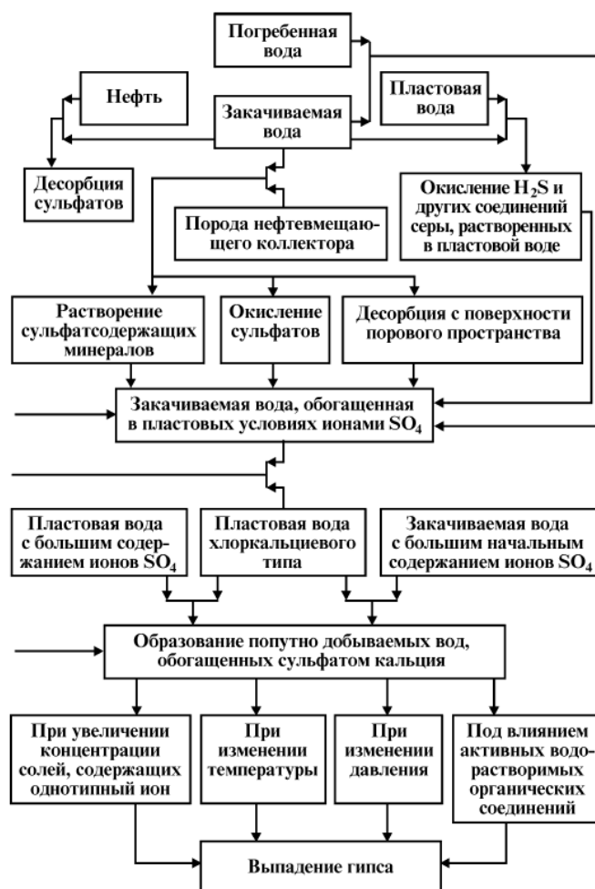
Рисунок 1 - Схема процессов, вызывающих гипсоотложения из попутно добываемых вод нефтяных месторождений [26, - С.461]
