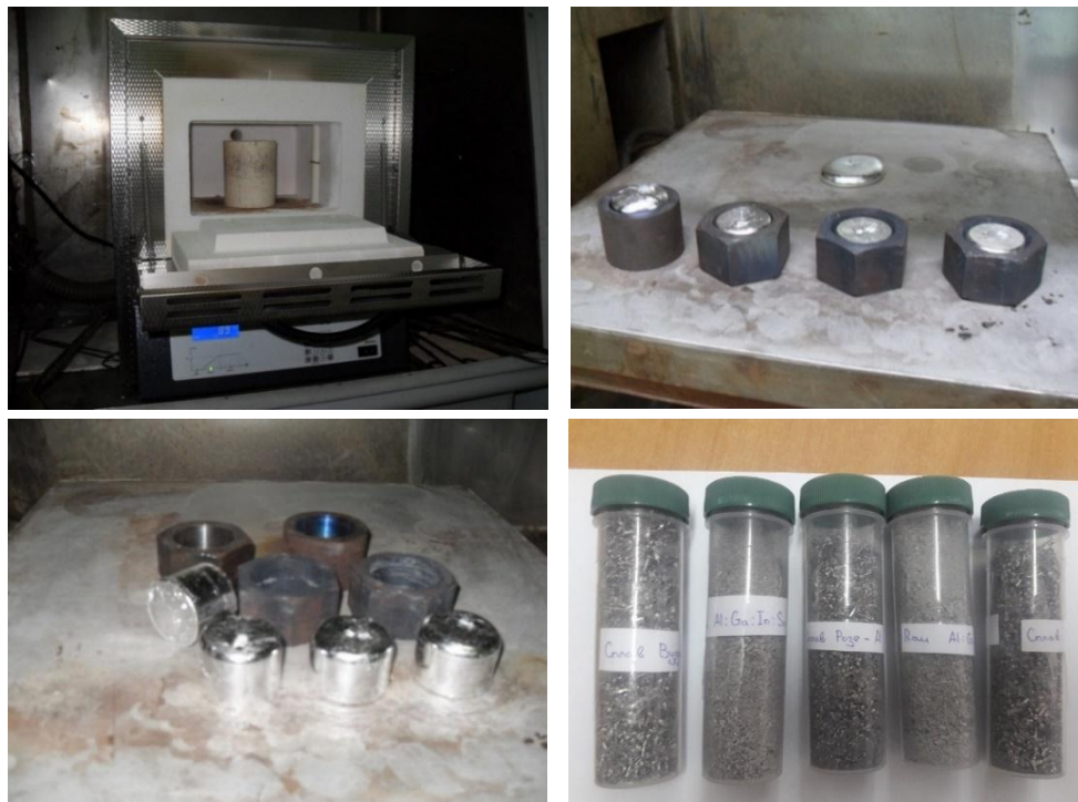
Рисунок 7 - Технология изготовления АСА и получение образцы порошков
