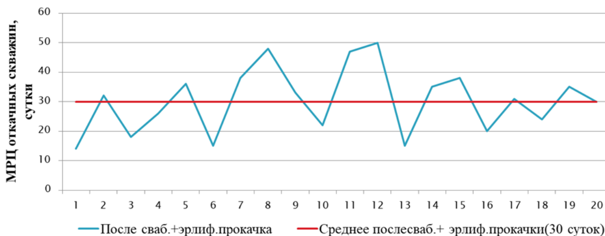
Рис.4.5 – Комплекс «Свабирование - эрлифтная прокачка»
