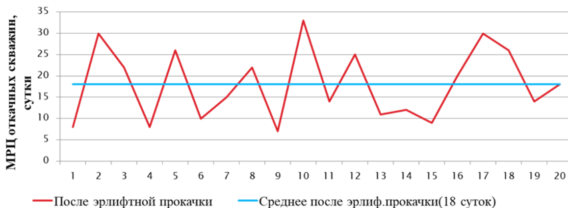
Рисунок 4.3 - Эрлифтная прокачка передвижным компрессором
