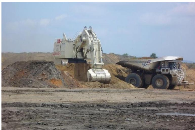
Рисунок 3.2 -Обычная схема погрузки самосвала экскаватором с обратной лопатой
