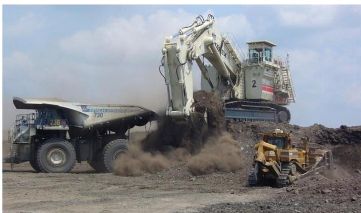
Рисунок 3.7- Расчистка и выравнивание полотна забоя
