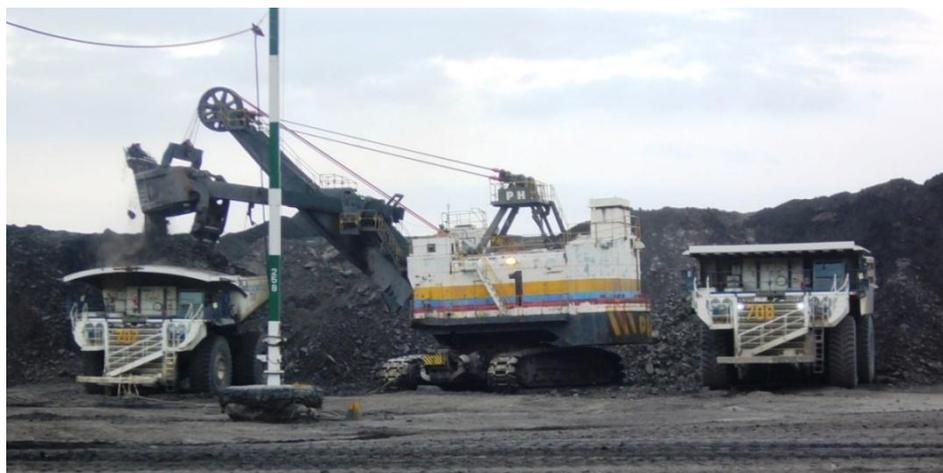
Рисунок 3.1-Двойная погрузка самосвалов
