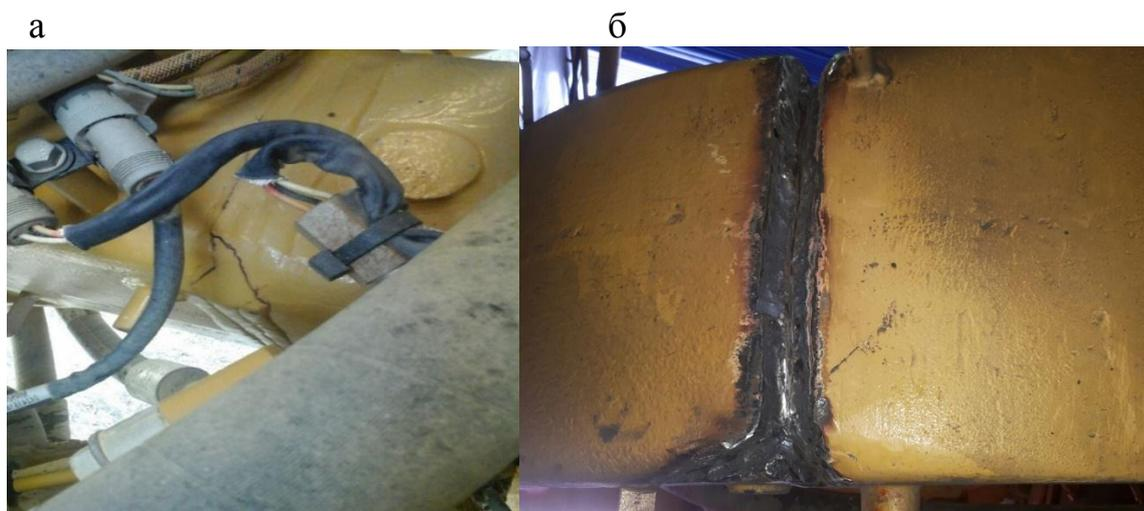
Рисунок 2.18 Примеры дефектов выявленных в процессе эксплуатации автосамосвалов Cat 785 в карьере Актогай ТОО KazMinerals: а) трещина рамы после сварки б) дефект верхнего кронштейна передней подвески
