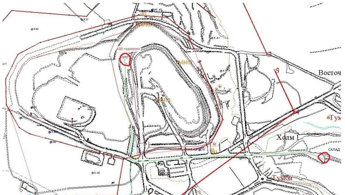
Рисунок 2.12 Схема движения автосамосвала до рудного складирования L=3 км на карьере Актогай
