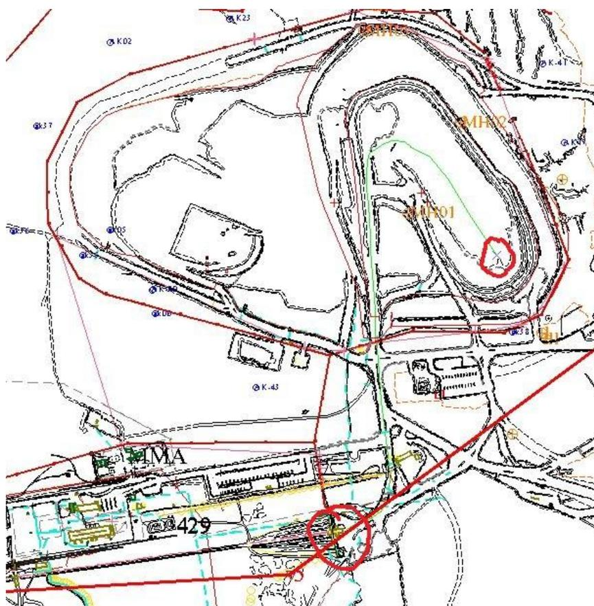
Рисунок 2.10 Схема движения автосамосвала с 370 горизонта в дробилку L=2.5 км на карьере Актогай
