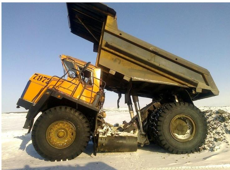
Рисунок 2.19 Последствия поломки продольных лонжеронов рамы.
