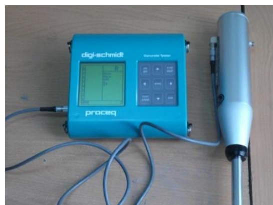
2-сурет. DIGI-SCHMIDT 2000 маркалы тексеру балғасымен бетон беріктігін анықтаудағы зерттеу жұмыстары
