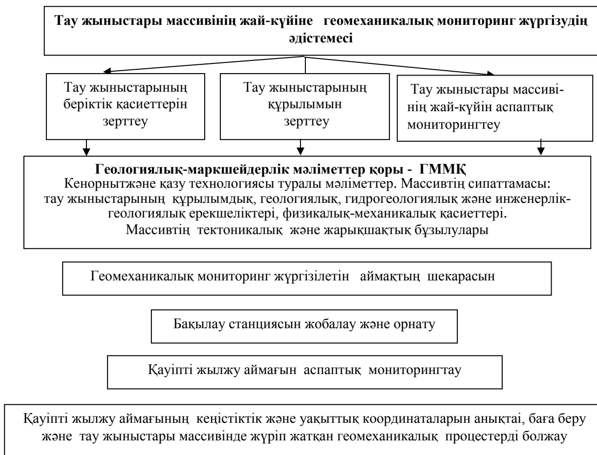
1-сурет. Геомеханикалық мониторинг жүргізудің әдістемесі
