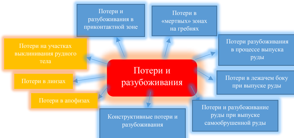
Рис. 2. Рабочая классификация потерь и разубоживания
