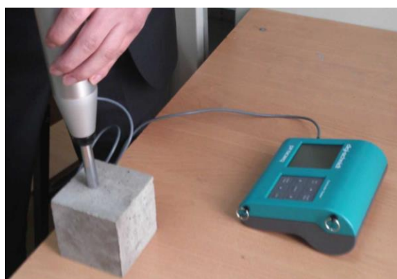
2-сурет. DIGI-SCHMIDT 2000 маркалы тексеру балғасымен бетон беріктігін анықтаудағы зерттеу жұмыстары
