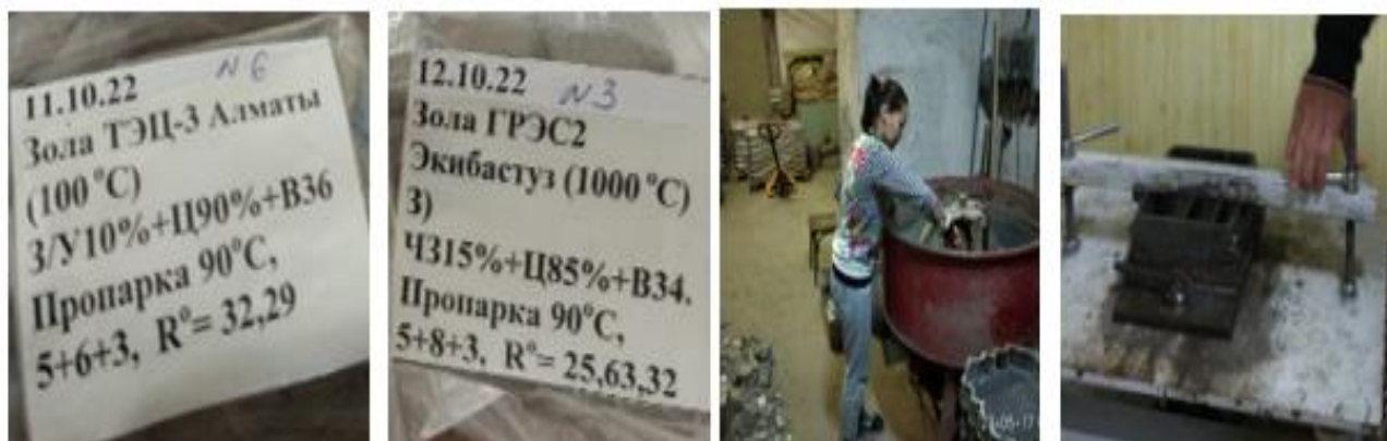
Рис. 3. Изучение золошлаковых отходов в лабораторных условиях
