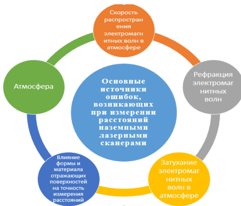
Рис. 2. Основные источники ошибок, возникающих при измерении расстояний наземными лазерными сканерами
