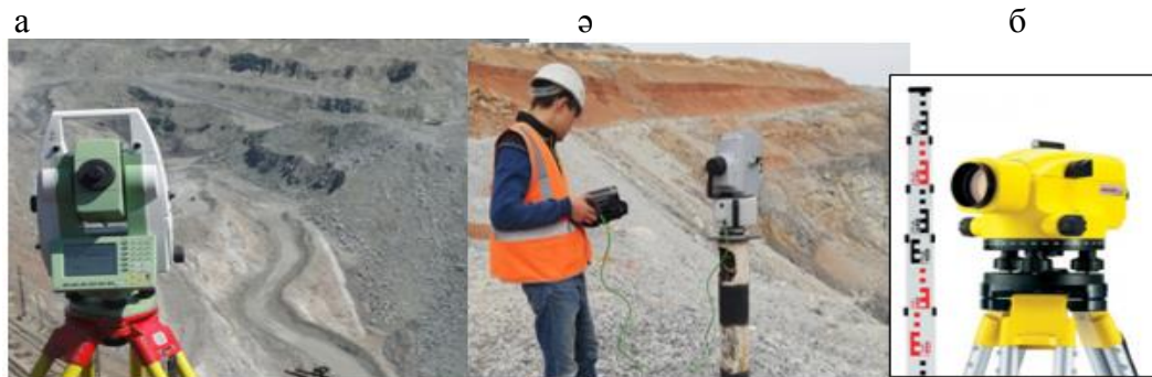
4-сурет. Акжал карьерінде қолданыстағы заманауи маркшейдерлі аспаптар
