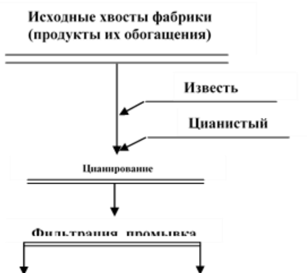
Рис. 2. Схема цианирования хвостов Чадакской ЗИФ и продукты их обогащения по иловому процессу
