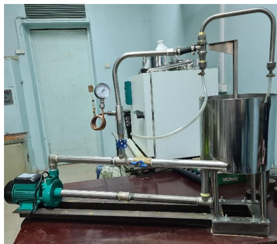
Рис. 2. Гидроциклонная установка для разделения глинисто-песчаной фракции 1-Гидроциклон; 2-Электродвигатель с центробежным насосом; 3-Манометр; 4-Вентиль плавной регулировки давления; 5-Шаровой вентиль; 6-Емкость для пульпы; 7- Патрубок верхнего слива гидроциклона; 8- Патрубок нижнего слива гидроциклона.
