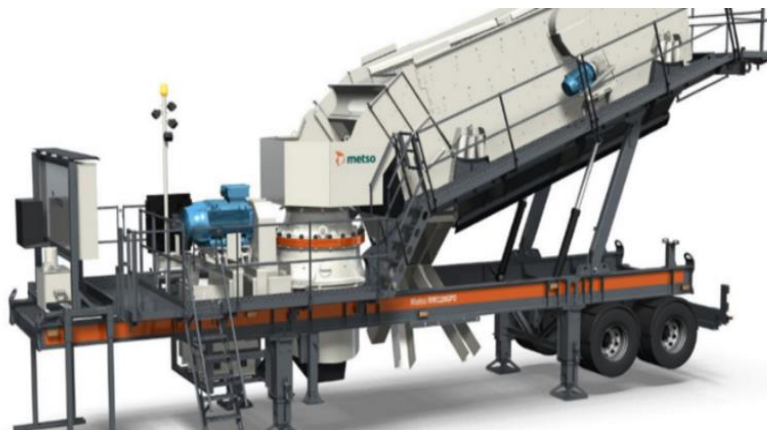
2-сурет. Nordberg gp220 конустық ұсатқышы бар Metso Nw220gpd мобильді ұсақтау және сұрыптау кондырғысы
