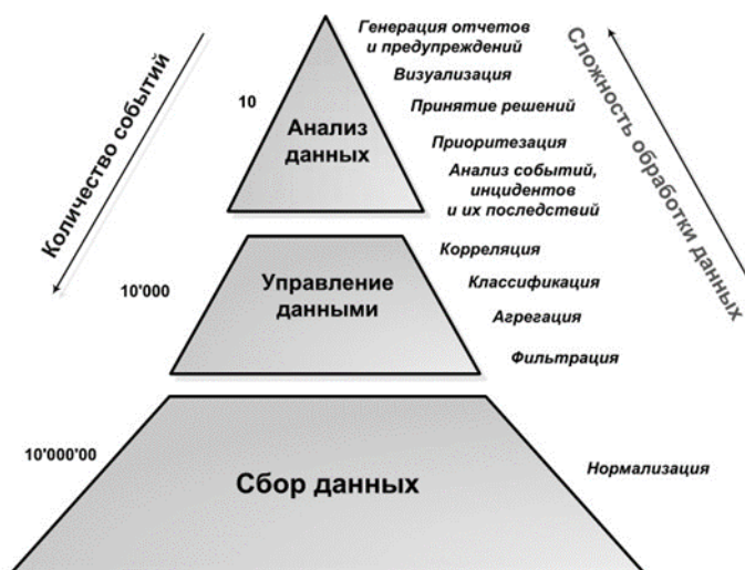
4 -Сурет. SIEM жүйесінің жалпыланған иерархиялық моделі
