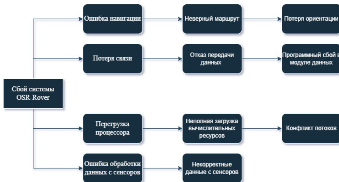
Рисунок 2 – Дерево отказов ПО OSR-Rover (анализ методом SFTA)
