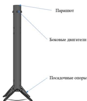
Рисунок 4 - Концепция вертикальной посадки первой ступени РНСЛК
