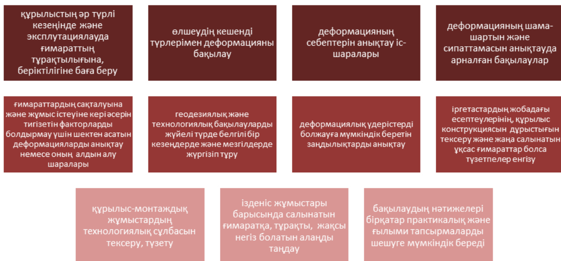
Сурет 6 - Деформацияларды бақылаудың геодезиялық және технологиялық ұйымдастырудың негізгі кезеңдері
