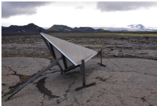
Сурет 46 – Бұрыштық шағылдырғыш. Өлшемдері 900x450 mm
