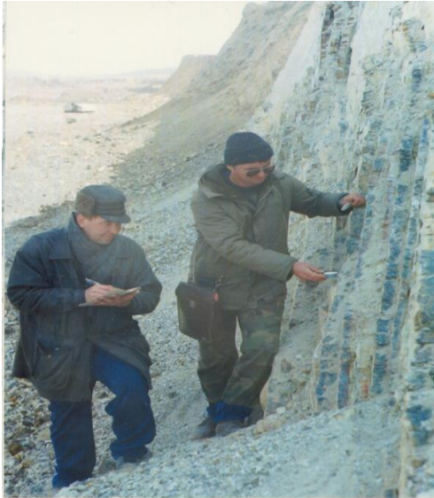
Сурет 2.5 - Карьерде сілемнің жарық пайда болған жерлерін компаспен түсіру
