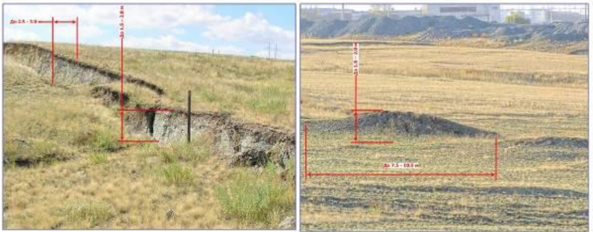
Сурет 1.9–Жерасты тау-кен жұмыстарының әсерінен жербетінің опырылуы, шұңқырлардың пайда болуы
