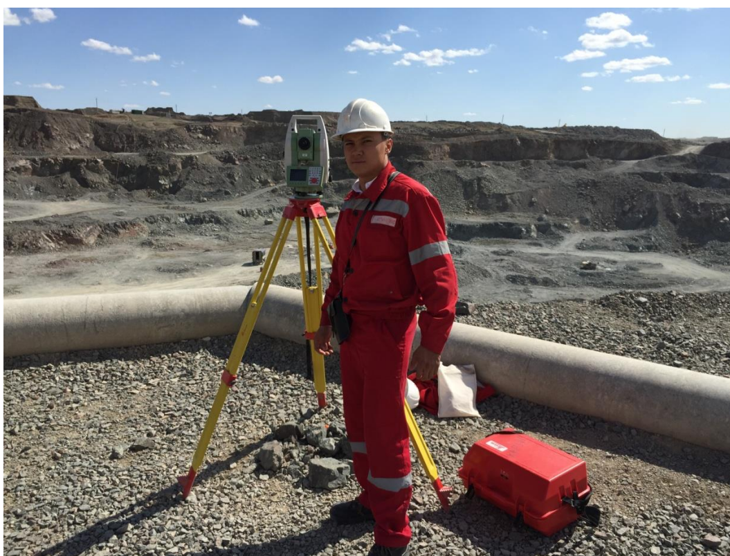
Сурет 3.18–Электронды тахеометрмен мониторинг жүргізу
