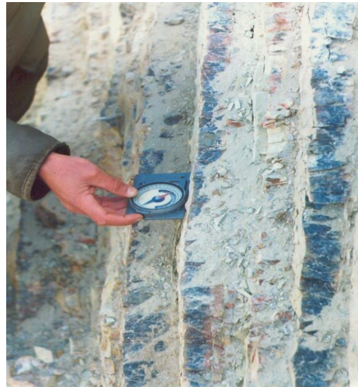
Сурет 2.5 - Карьерде сілемнің жарық пайда болған жерлерін компаспен түсіру
