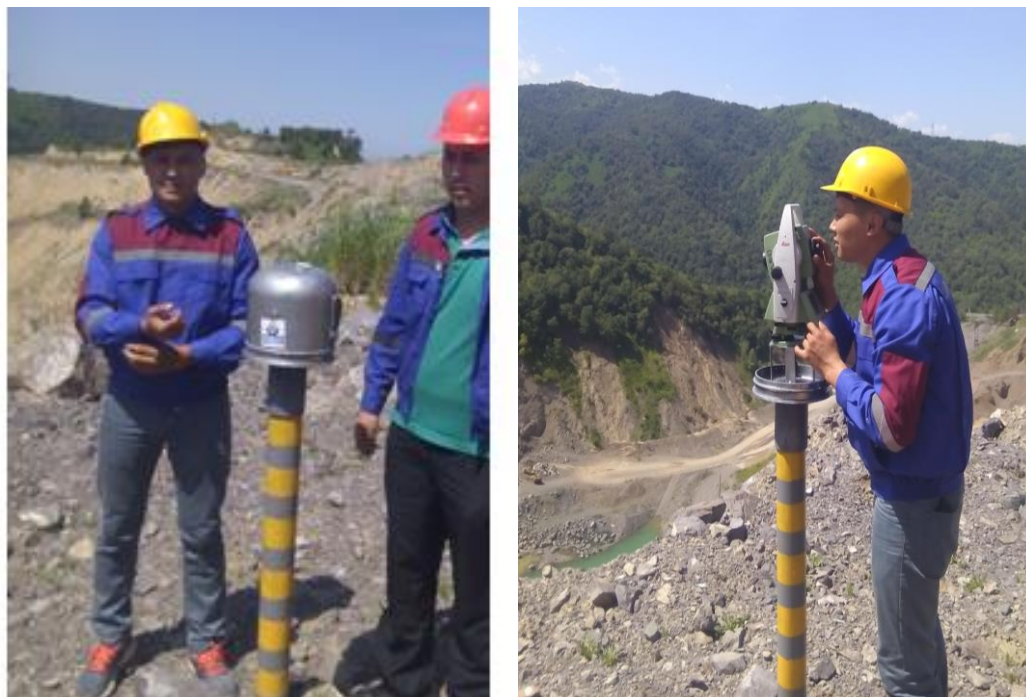
Сурет 3.20- Қотырбұлақ карерінде грунттық реперді сынақтан өткізу
