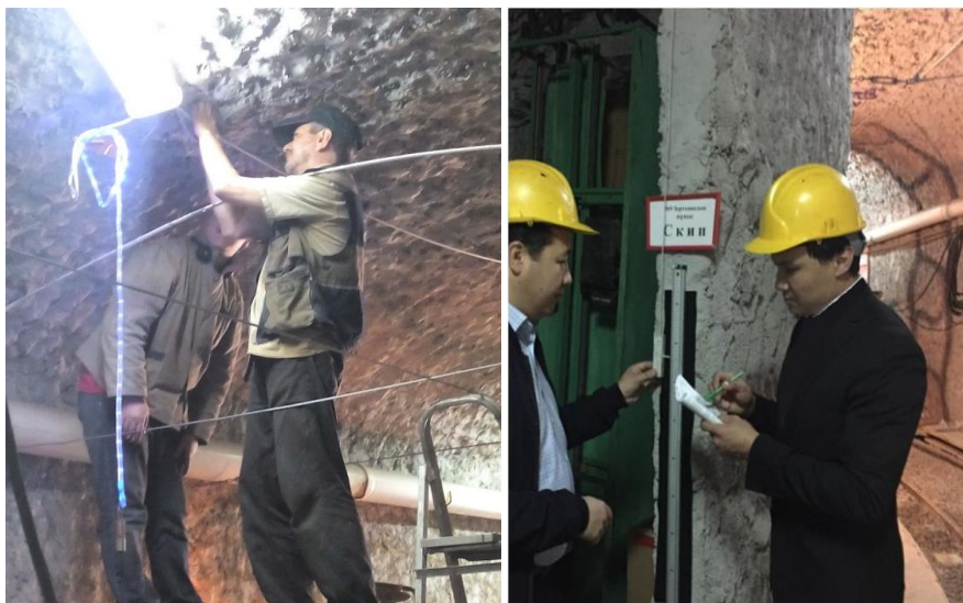
а- иілімелі пластинаны төбеге керу; ә- қазбаның қарама-қарсы қабырғасына бекітілген жабдықтан есеп алу кезі
