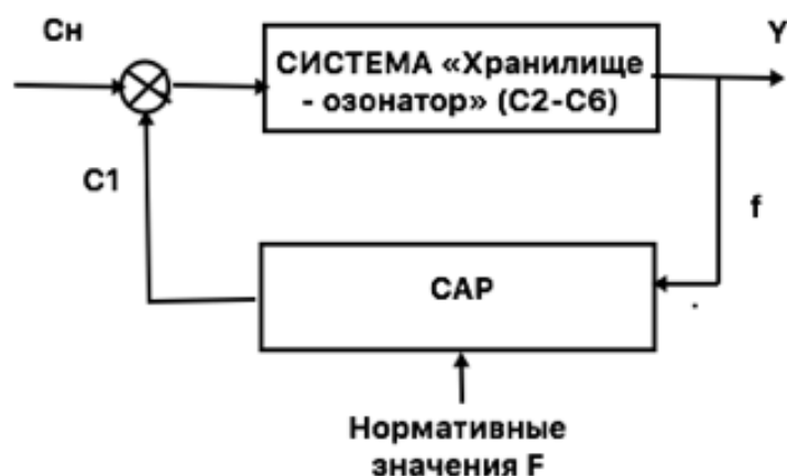
Рисунок 1.6 – Управление автоматизированной установки озонирования воздуха
