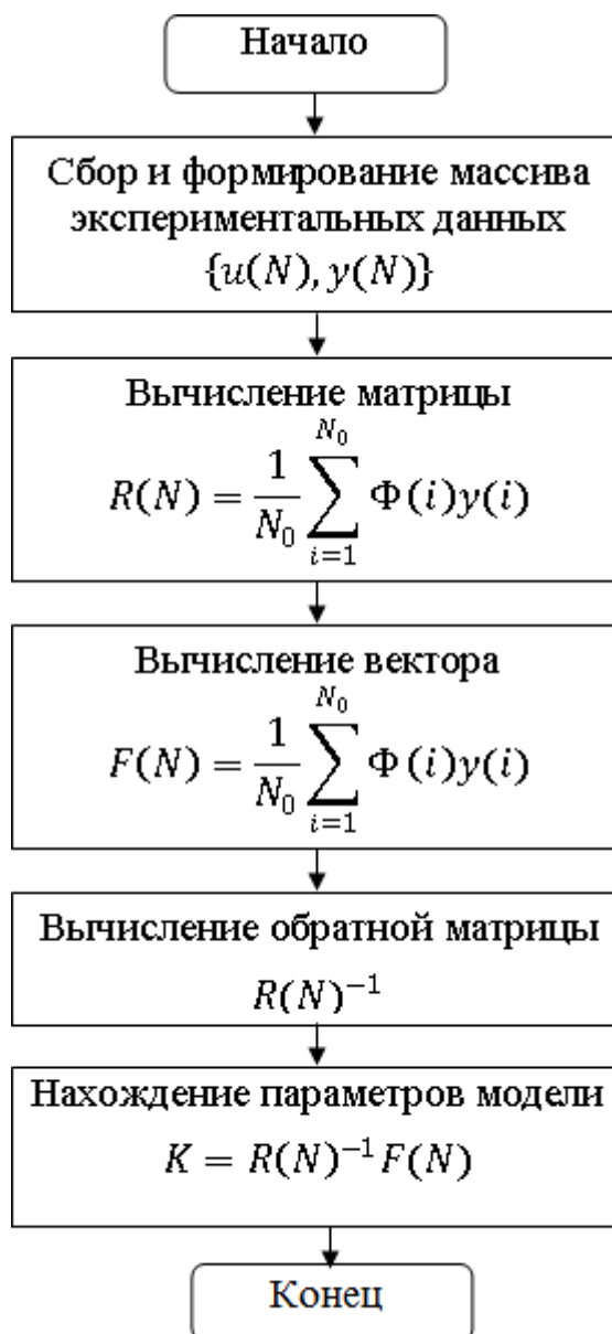
Рисунок 4.10 – Блок-схема алгоритма МНК нахождения параметров АПМ
