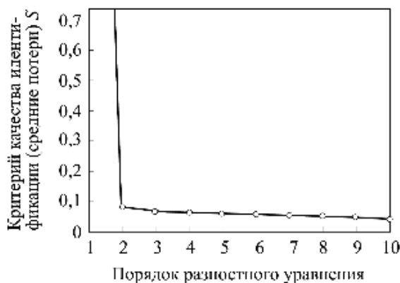
Рисунок 4.15 – Зависимость качества идентификации от порядка аппроксимирующего разностного уравнения (морковь)
