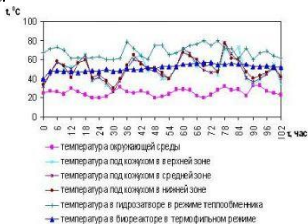
Рисунок 1.17 – Зависимости параметров метантенка от времени при нагреве в термофильном режиме
