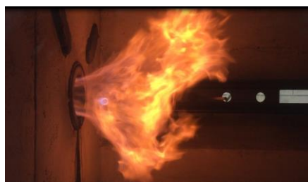
Рисунок 3.3 – Факел пламени, полученный при сжигании биогаза в лабораторной установке
