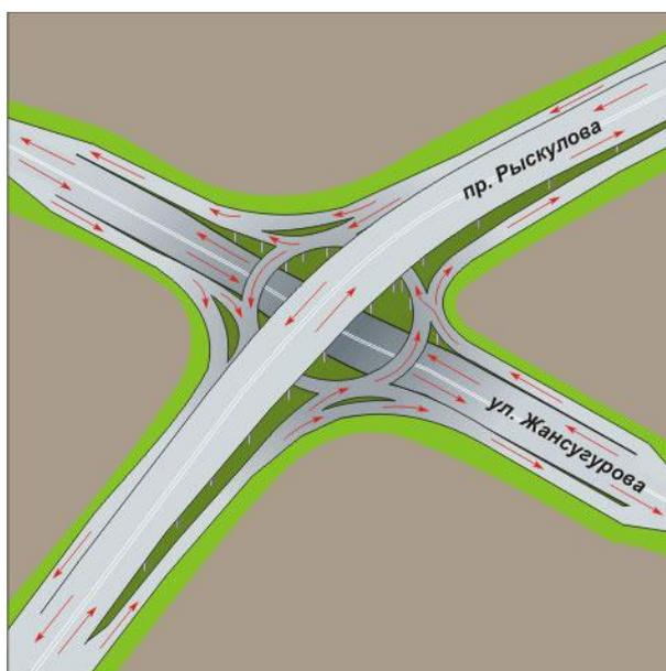
Рисунок 2.27 - Схема “распределительного кольца” с пятью путепроводами
