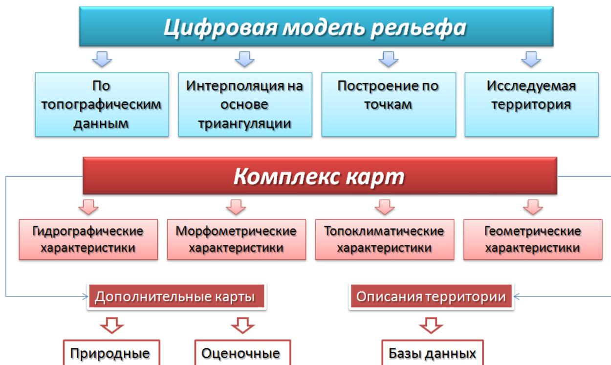
Рисунок 2.5 - Последовательность создания ЦМР
