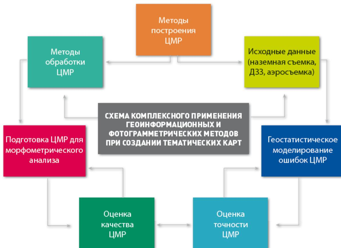
Рисунок 4.19 - Схема комплексного применения геоинформационных и фотограмметрических методов при создании тематических карт местности
