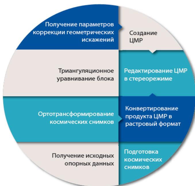
Рисунок 4.1 - Получение ЦМР (цифровой модели рельефа)
