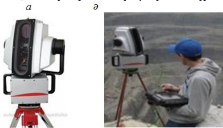
Сурет 3.16 - а- жер бетілік тау-кен жер лазерлік сканері; б-сканирлеу және планшеттегі скандарды тексеру үдерісі
