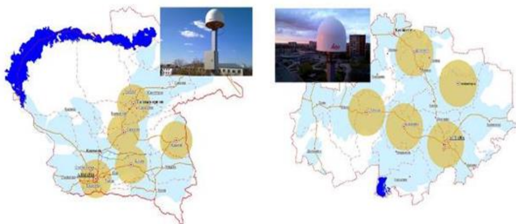
Сурет 3.7 - «Қазақстан Ғарыш Сапары» Ұлттық компаниясының тұрақты базалық станциялар жүйесі
