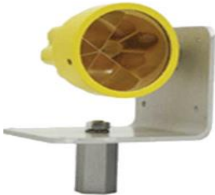
Сурет 4.14–Мониторингтік призма және шөгу маркасы
