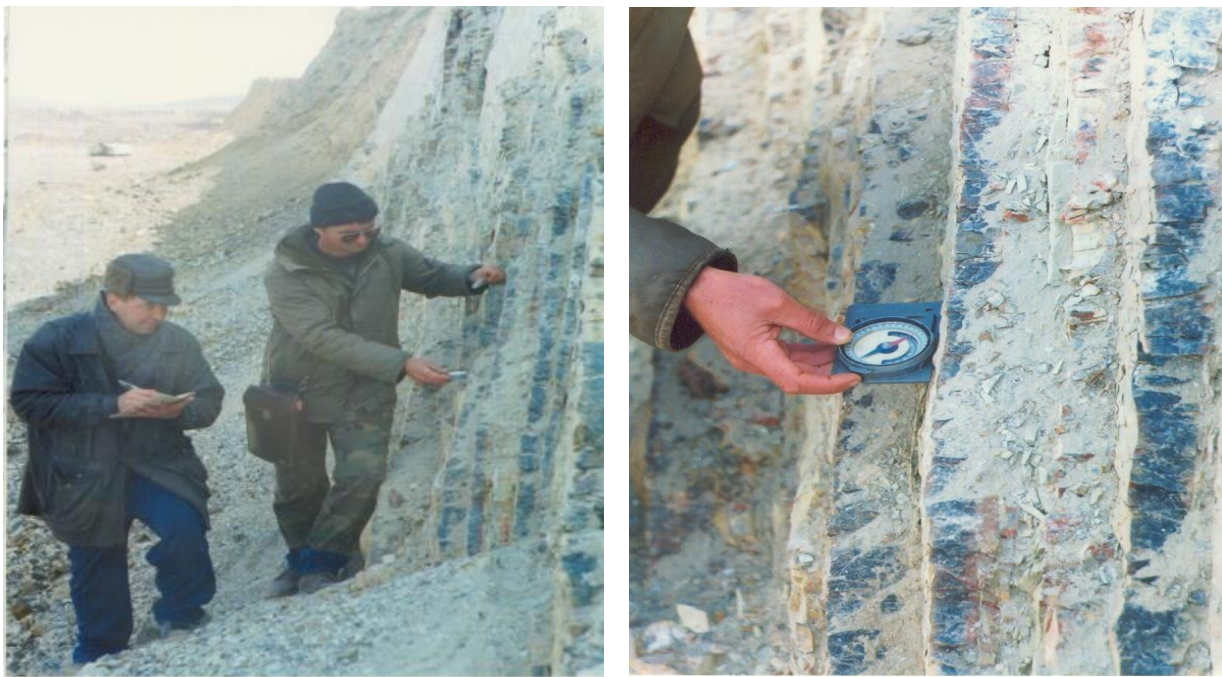
Сурет 2.12- Карьерде массивтің жарықшақтылығын түсіру
