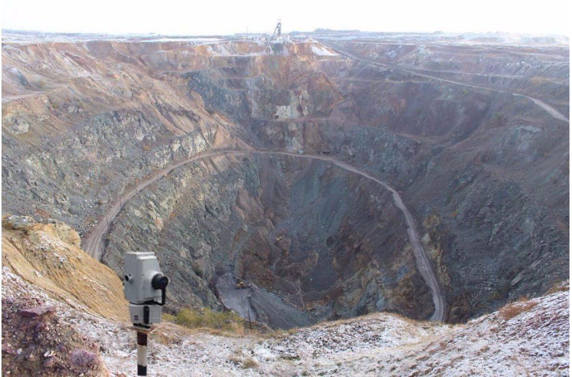
Сурет 3.18 - Майқайың карьеріндегі тұрақты реперге орнатылған Leica HDS8810 лазерлік сканері
