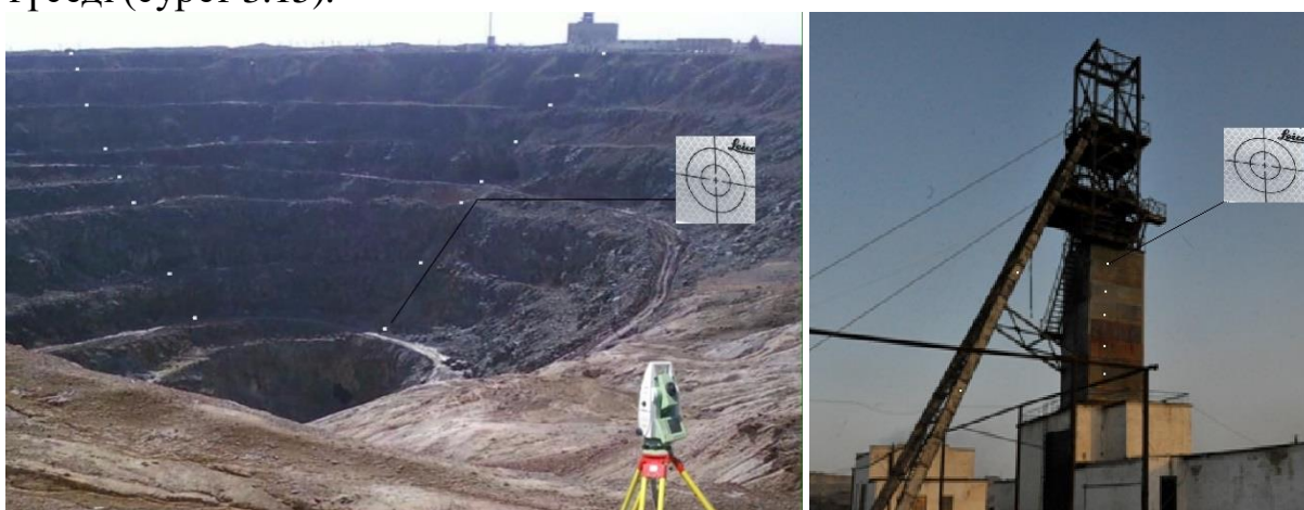
Сурет 3.15 - Инженерлік құрылыстар мен карьер кемерлеріндегі реперлері электронды тахеометрмен бақылау
