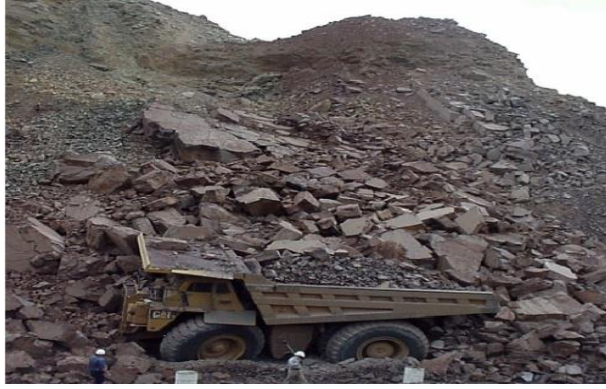
Сурет 1.1 - Карьер беткейлерінің опырыла құлауы
