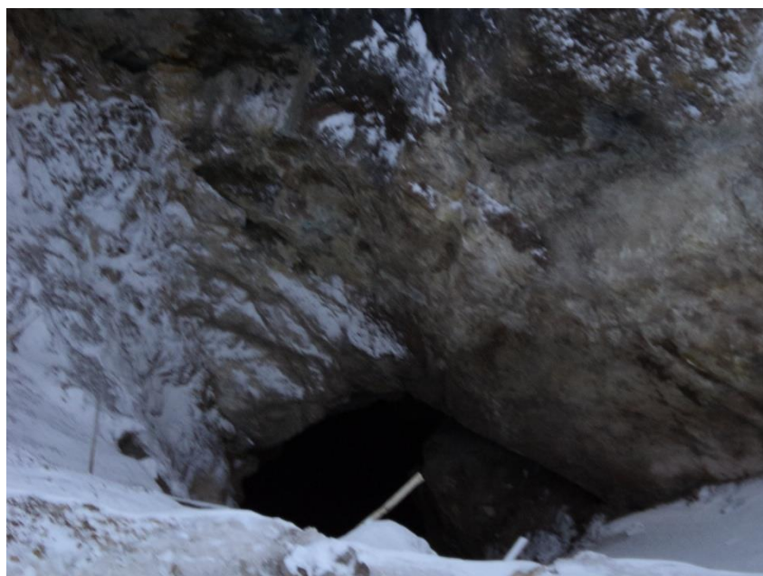
Сурет 2.19- Карьер түбінде шұңқырлар (воронки) пайда болуы
