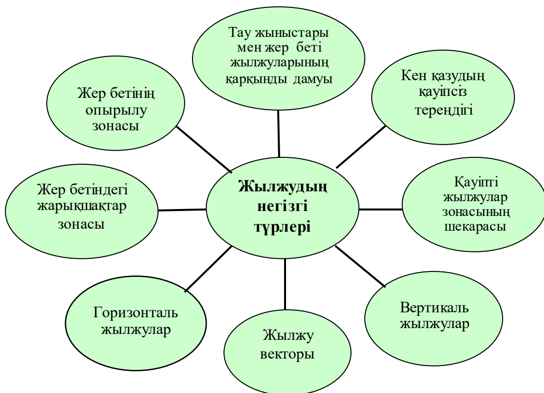
Сурет 1.2 - Карьер беткейлері жылжудың түрлері
