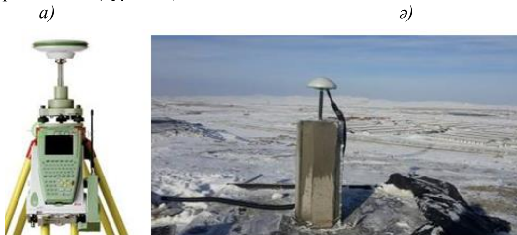
а) тасымалды және ә) тұрақты жеке базалық станциялар
