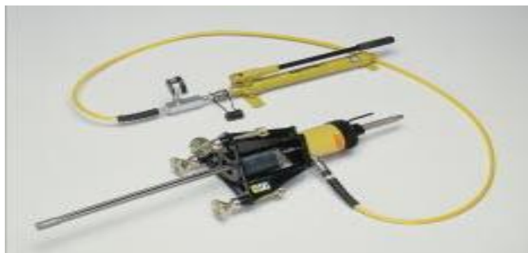
Рис. 1.24 - Гидравлический прибор для испытания анкеров «Swellex® Pull-test Equipment»
