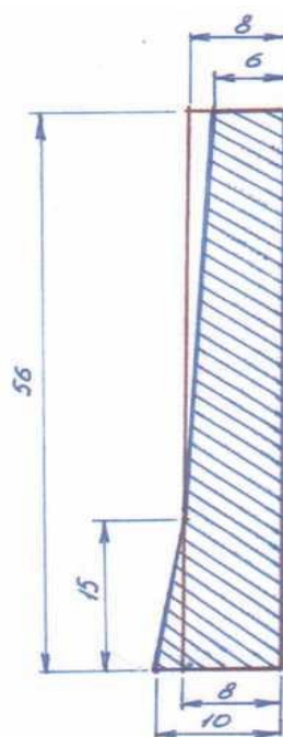
Рисунок 4.18 - Модернизированная конфигурация лопатки импеллера
